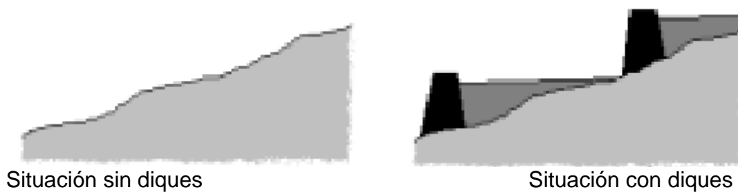
Figura N° 2.6: Estabilidad de pendientes en cárcavas o quebradas)
