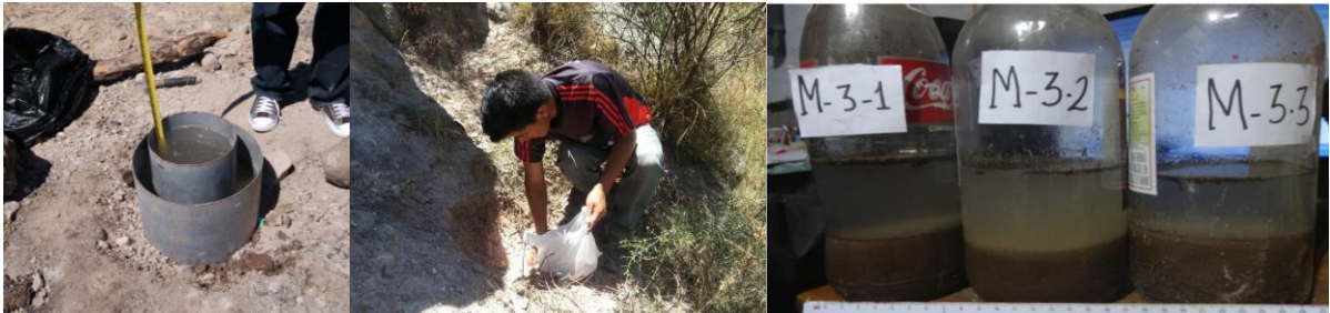
Figura N° 3.4: Tiempo de infiltración y tomas de muestras de suelos
