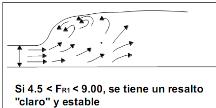
Figura N° 2.29: Salto hidráulico, de acuerdo al número de Froude
