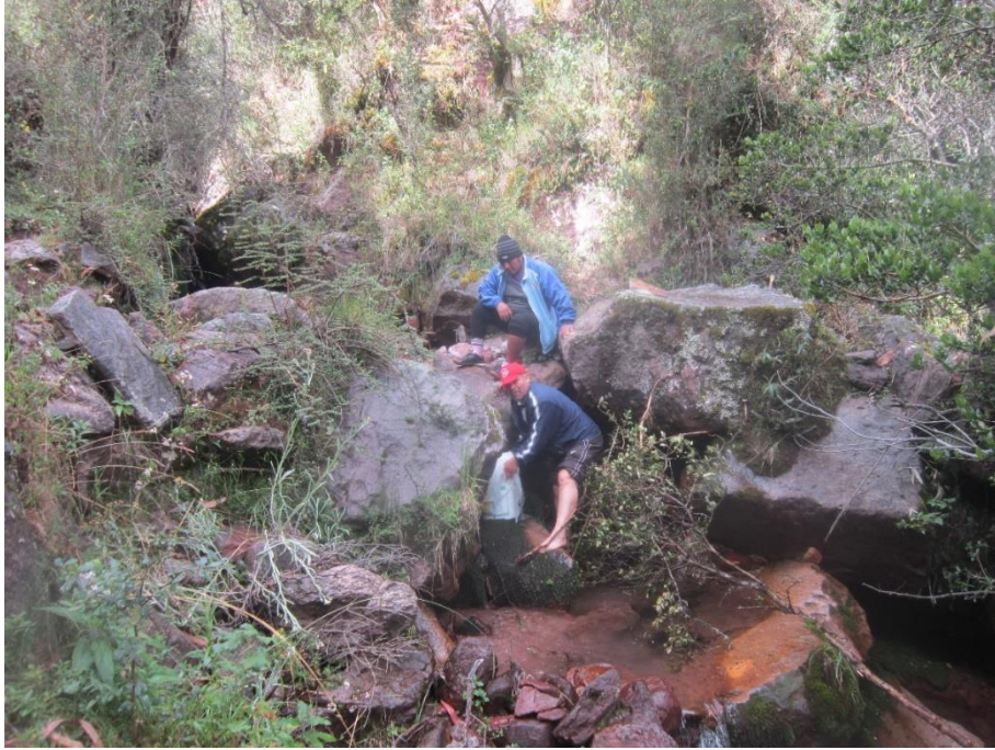
Figura Anexo 1- 15 Aforo volumétrico de la quebrada Quinua
