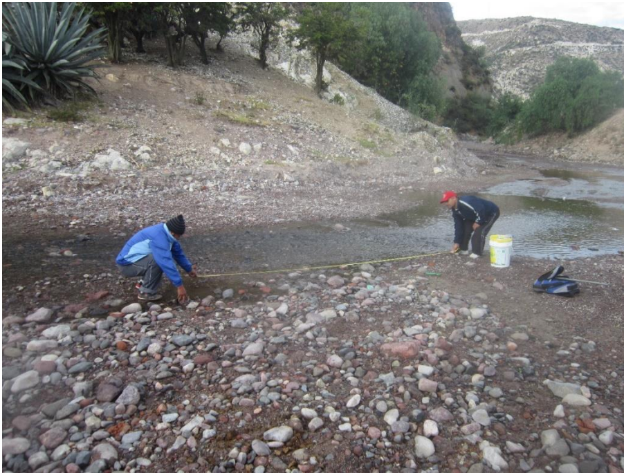
Figura Anexo 1- 7 Midiendo para aforo en el río Huayllapampa
