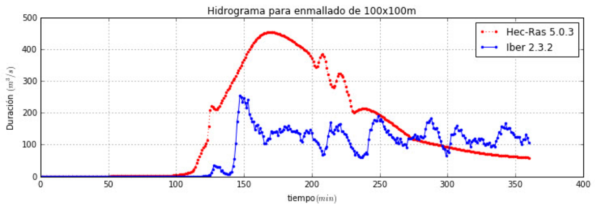
Figura 4.30: Comparación de hidrogramas Hec-Ras e Iber para un enmallado de la cuenca en celdas de 100x100m
