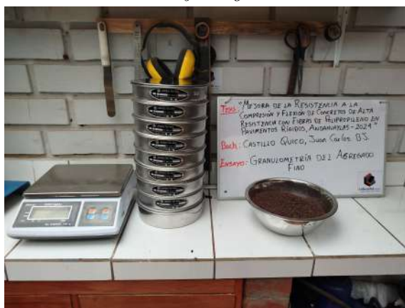
Figura 3.9: Realización del ensayo de granulometría en el agregado fino
