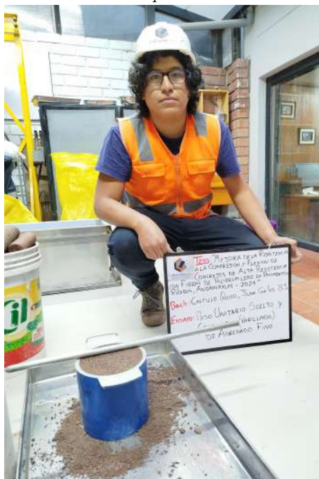
Figura 3.18: Llenado de recipiente con el material fino suelto
