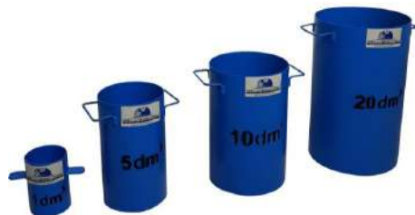
Figura 2.8: Recipientes para el cálculo del peso unitario de diferentes tamaños
