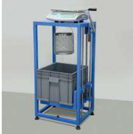
Figura 2.10: Equipo para sumergir y pesar simultáneamente el agregado
