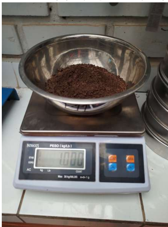
Figura 3.8: Muestra del agregado fino para el ensayo de granulometría
