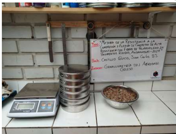
Figura 3.6: Realización del ensayo de granulometría en el agregado grueso
