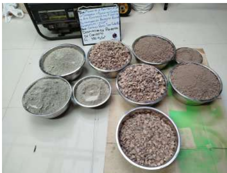
Figura 3.40: Dosificación de materiales para una mezcladora de capacidad de 50Kg
