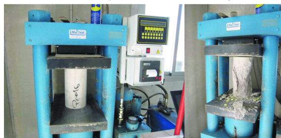
Figura 2.16: Rotura de probeta durante ensayo de compresión
