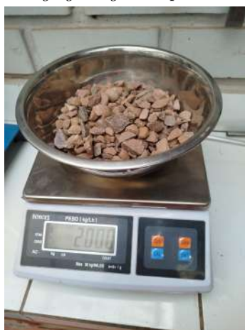
Figura 3.5: Muestra del agregado grueso para el ensayo de granulometría
