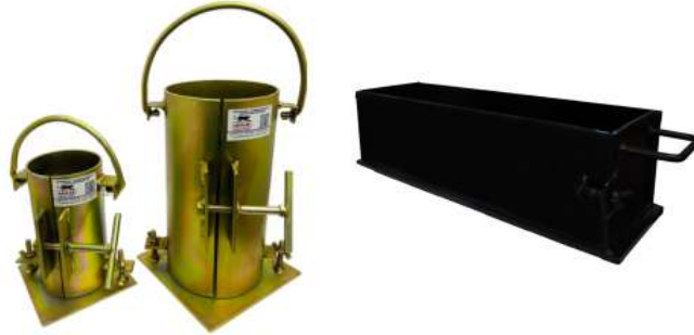
Figura 2.13: Moldes para probetas y vigas, respectivamente
