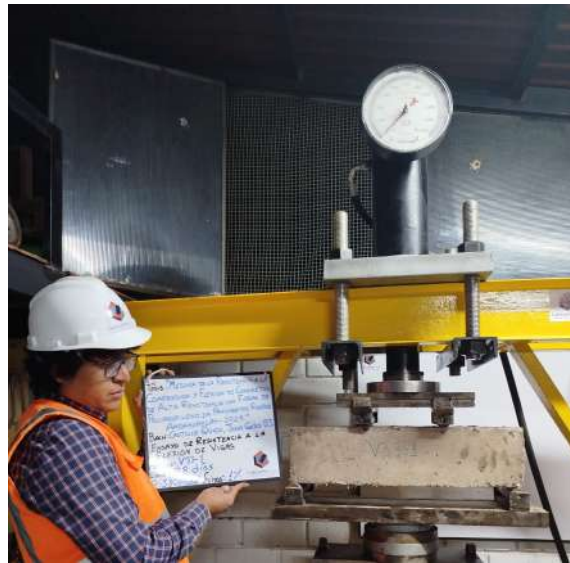
Figura 3.49: Inicio de ensayo de resistencia a la flexión en la viga V33-1 de 28 días de edad
