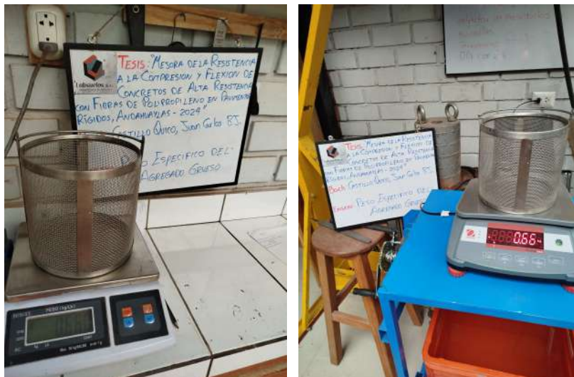
Figura 3.24: Pesado de canastilla en dos distintas balanzas
