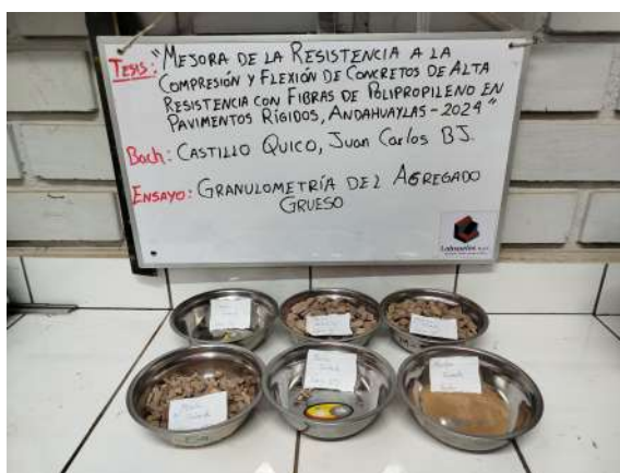
Figura 3.7: Muestras retenidas en cada tamiz durante el ensayo de granulometría en el agregado grueso
