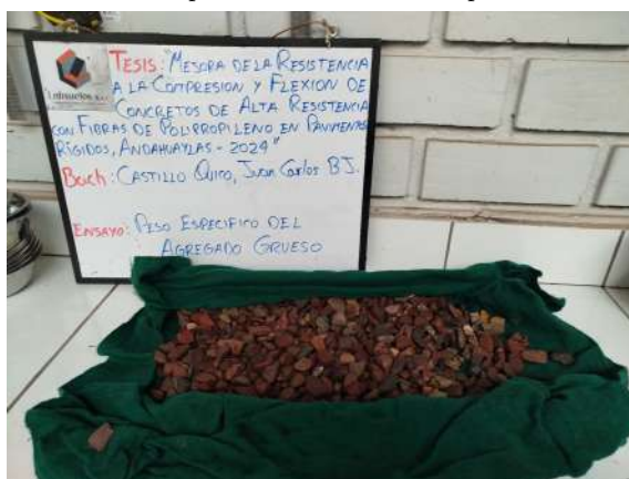
Figura 3.22: Secado parcial de la muestra previamente saturada
