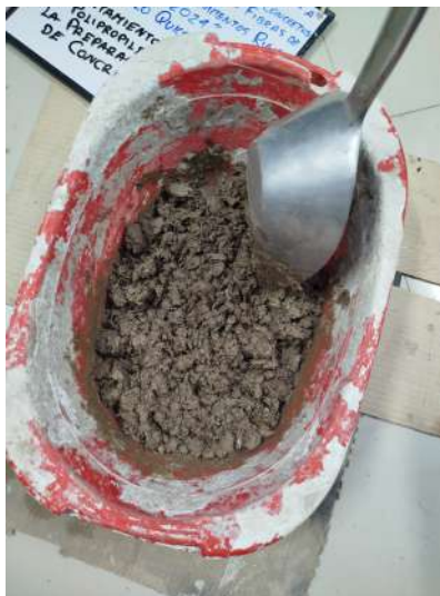
Figura 3.37: Comportamiento del concreto ante la adición de fibras
