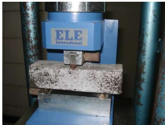
Figura 2.18: Rotura de viga durante ensayo de flexión
