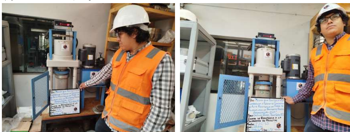
Figura 3.48: Inicio de ensayo de resistencia a la compresión en las probetas P41-0 y P32-1.5 de 14 y 28 días de edad, respectivamente
