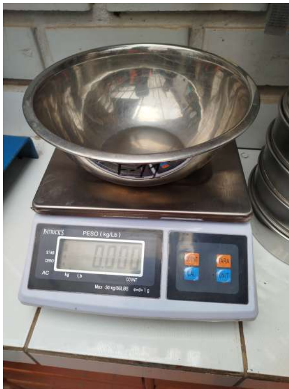
Figura 2.3: Balanza calibrada y bandeja tarada
