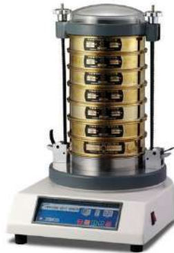
Figura 2.7: Tamizado mecánico de la muestra
