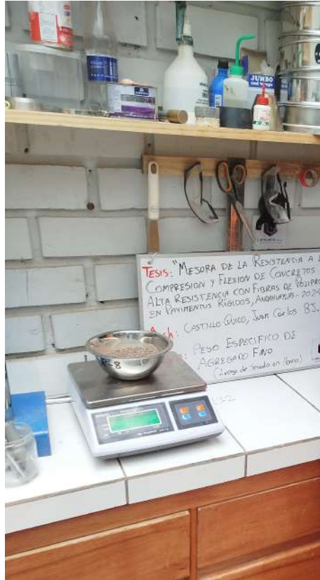
Figura 3.33: Pesado final del material fino seco en horno
