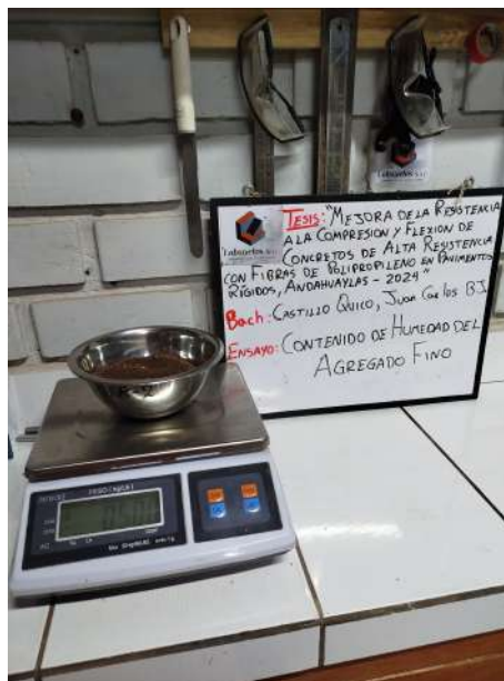
Figura 3.13: Pesado de muestra del agregado fino para el ensayo de contenido de humedad
