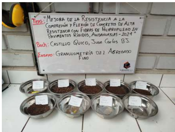
Figura 3.10: Muestras retenidas en cada tamiz durante el ensayo de granulometría en el agregado fino
