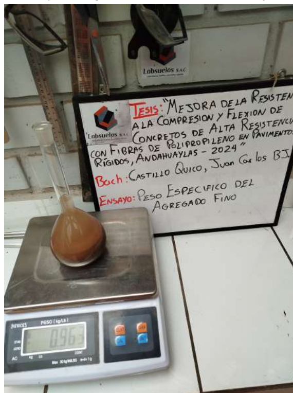
Figura 3.31: Masa de fiola luego de introducir la muestra y ser llenada con agua
