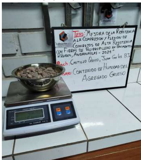
Figura 3.11: Pesado de muestra del agregado grueso para el ensayo de contenido de humedad
