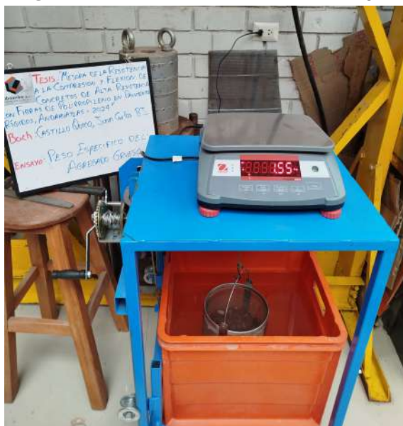
Figura 3.26: Pesado de la muestra sumergida
