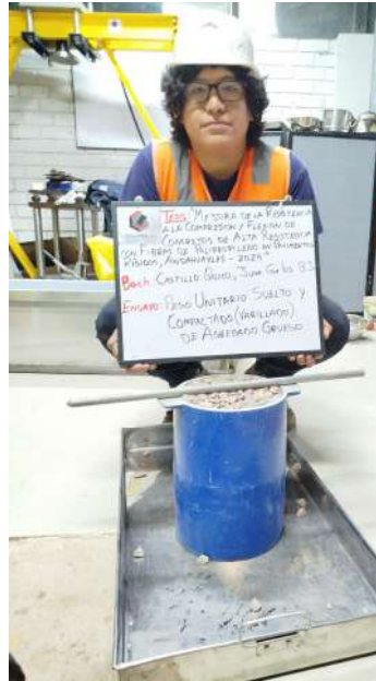
Figura 3.16: Llenado de recipiente con el material grueso suelto
