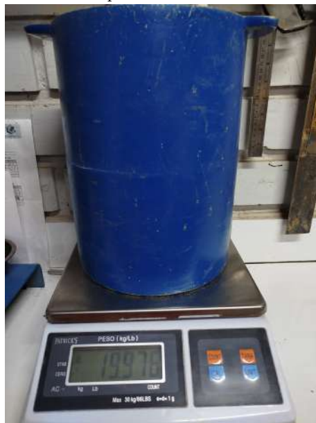
Figura 3.17: Pesado del recipiente llenado con el material grueso suelto
