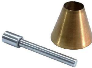
Figura 2.11: Cono y apisonador para agregado fino
