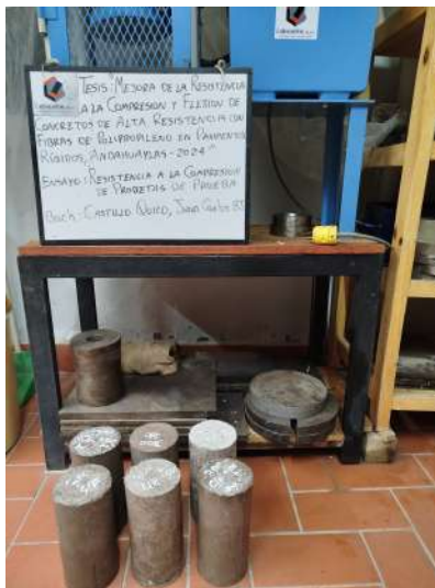
Figura 3.38: Probetas de prueba de dimensiones 8"x 4"
