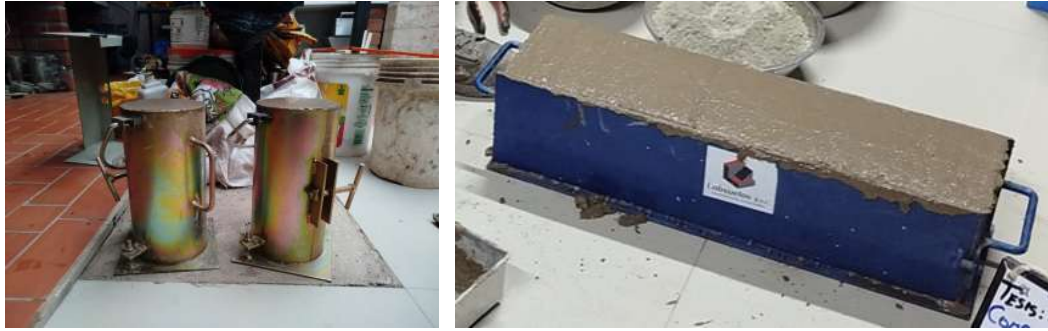
Figura 2.15: Fraguado de las probetas y vigas elaboradas
