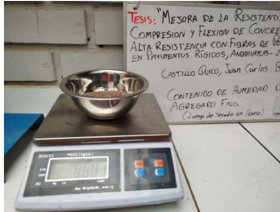
Figura 3.14: Pesado de muestra del agregado fino luego de su secado en el horno para el ensayo de contenido de humedad
