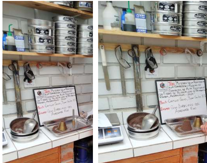
Figura 3.28: Prueba del cono en el agregado fino, previo secado y tamizado en la malla N° 4
