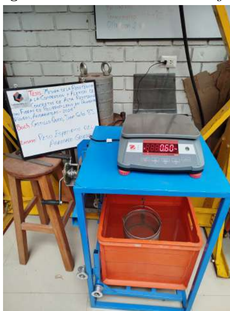
Figura 3.25: Canastilla vacía sumergida
