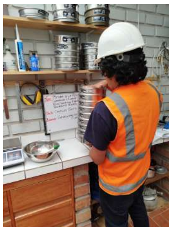
Figura 3.4: Proceso de tamizado manual
