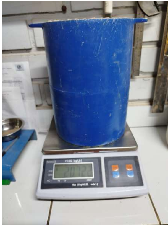
Figura 3.20: Pesado de recipiente luego de llenarlo con el material grueso compactado
