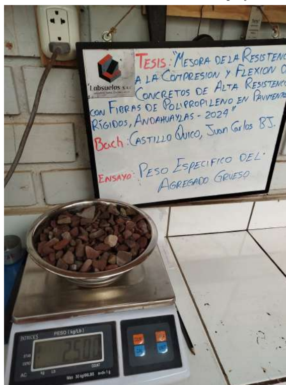
Figura 3.23: Pesado de muestra saturada superficialmente seca
