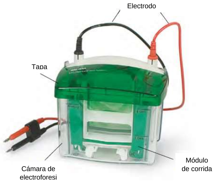
Figura 3. Componentes de la cámara de electroforesis vertical (Bio-Rad, s. f.-d)
