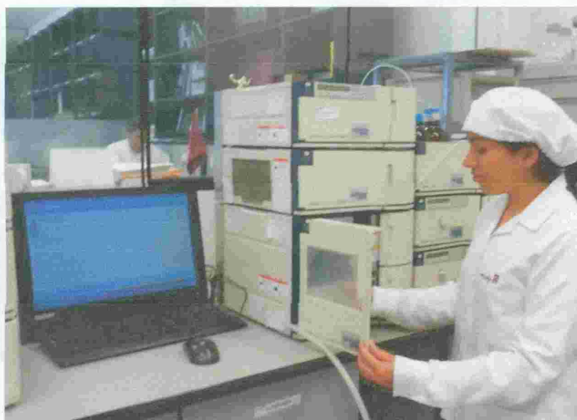
ANEXO Nº 18. Programación del cromatografo líquido de alta eficiencia (HPLC – Merck Hitachi Lachrom Elite).
