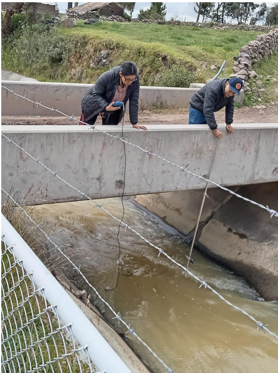
Figura 40 Medición de los caudales de entrada perspectiva 2
