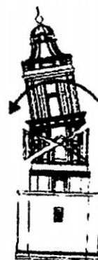
Figura N° 2-21.- Corte diagonal en campanarios
