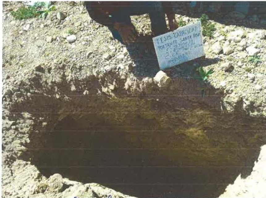
Figura 08. Calicata C – 08, Coordenadas 583456.31 E/ 8549065.07 N, Prof. 0.00 – 2.60 m
