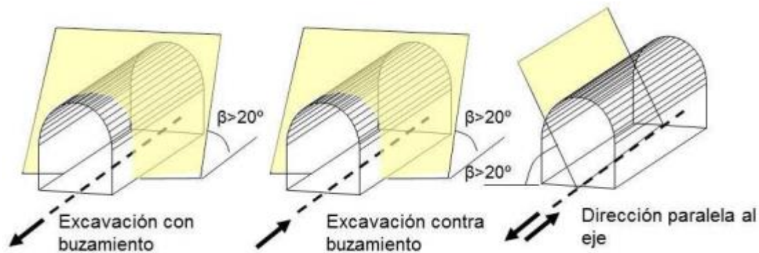
Figura 7: excavación en relación a las capas
