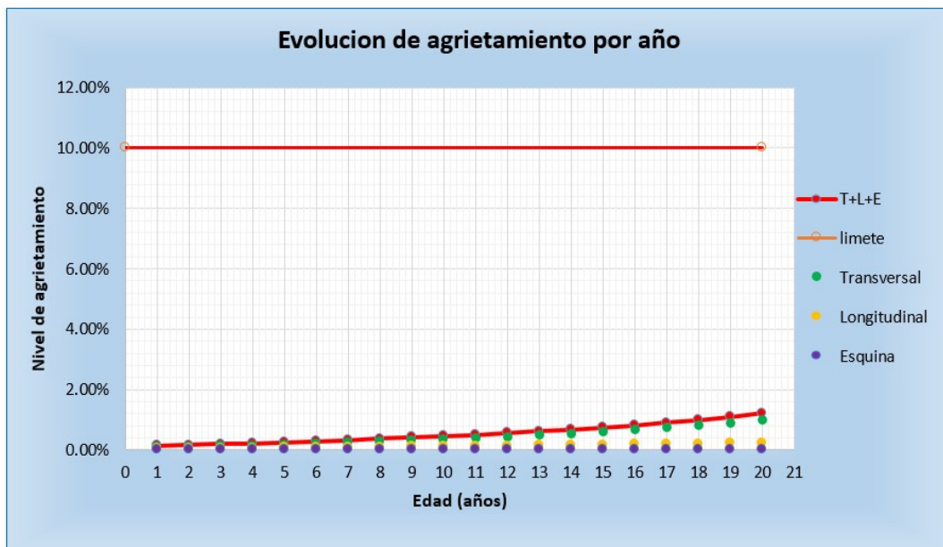
Figura 58 Agrietamiento total para pavimento rígido
