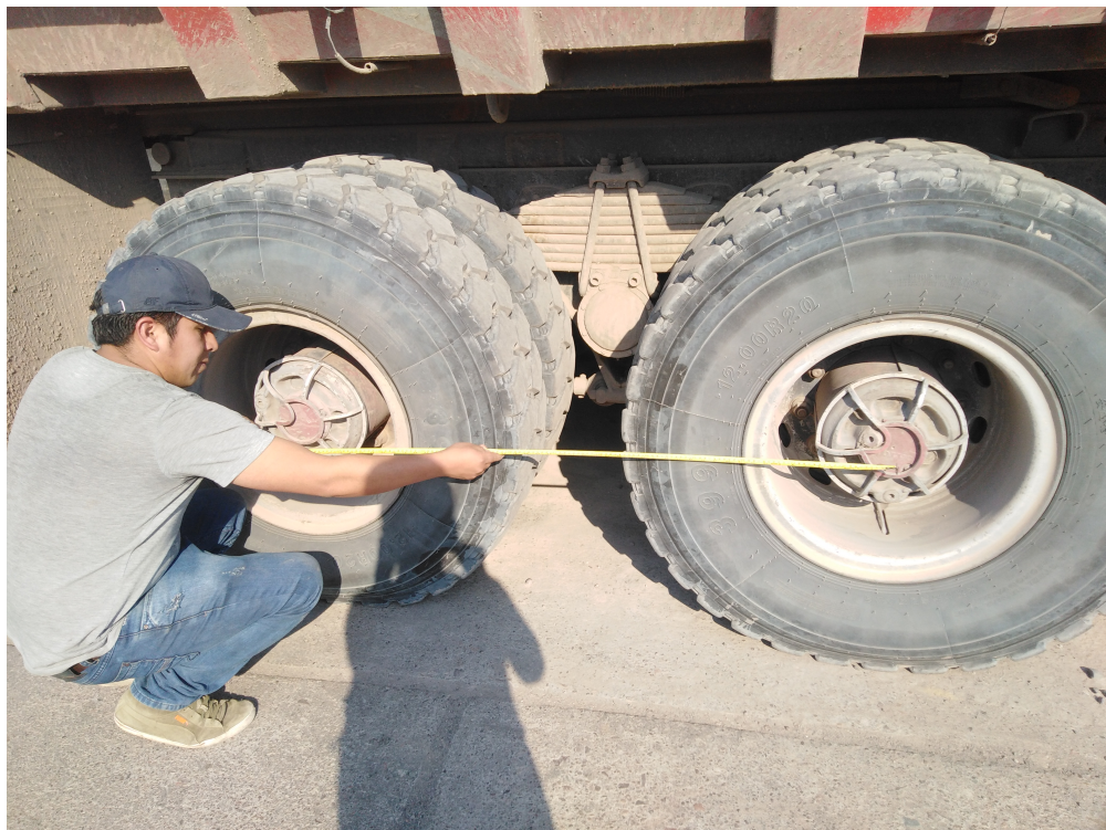
Figura 88 Medición de neumático de camión C3
