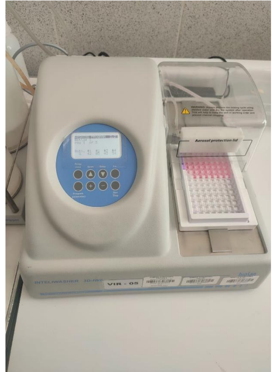
Figura 5. Proceso de lavado automatizado (Biosan IntelliWasher 3D-IW8) de las muestras de heces para el examen de Elisa Ag para rotavirus referidas al laboratorio.
