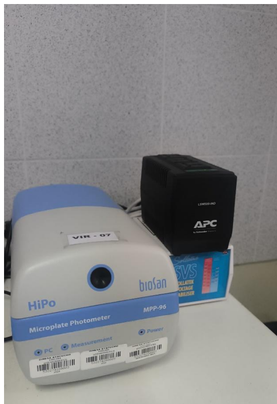
Figura 8. Lectura de resultados mediante el lector ELISA (Biosan) para rotavirus a 450 nm a 620 nm de referencia.
