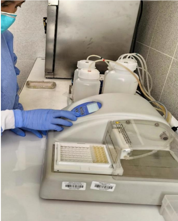
Figura 5. Proceso de lavado automatizado (Biosan IntelliWasher 3D-IW8) de las muestras de heces para el examen de Elisa Ag para rotavirus referidas al laboratorio.
