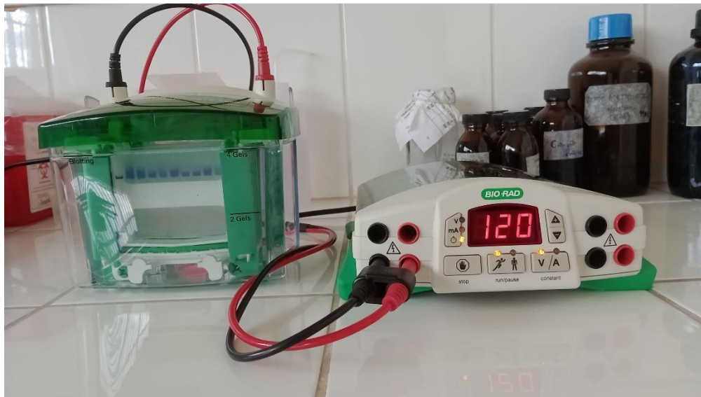
Figura 12. Electroforesis 1D – SDS PAGE con el equipo Mini-PROTEAN Tetra System – BioRad. Laboratorio de Biotecnología, UNSCH, Ayacucho 2023.
