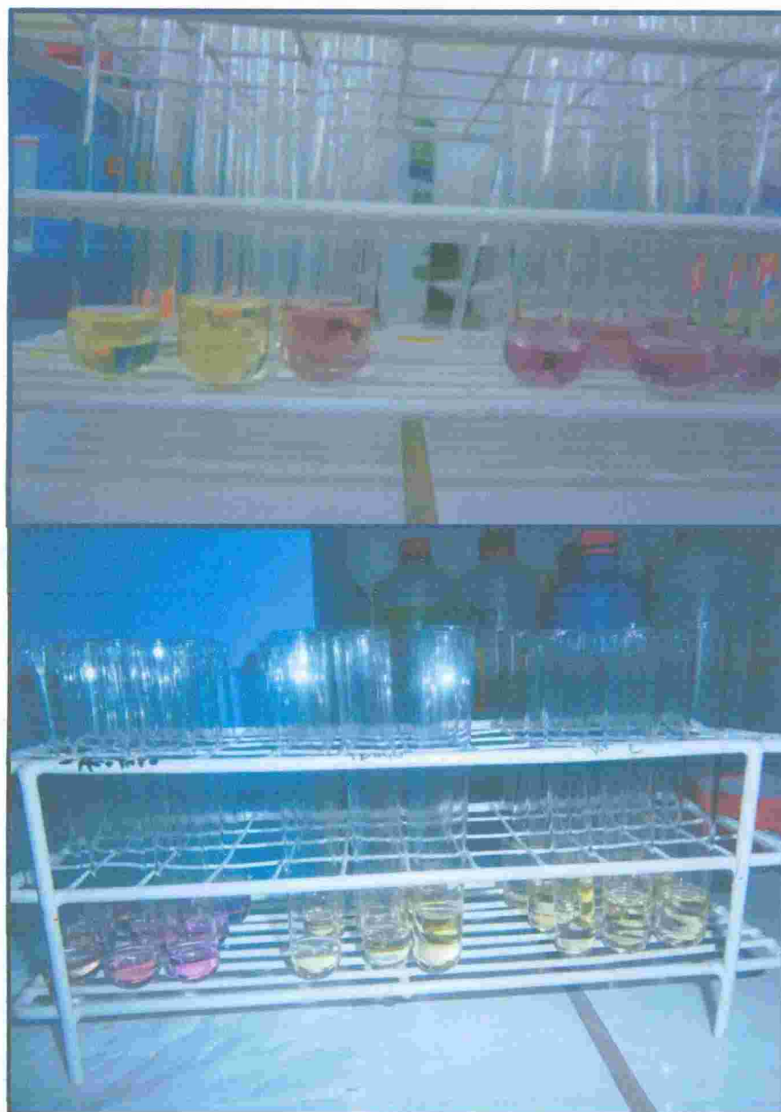
Figura 13. Tubos de ensayo con la prueba de captación de radical libre DPPH del extracto hidroalcohólico y de las fracciones.
