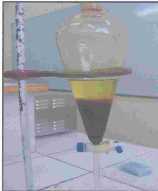
Figura 11. Extracción líquido – líquido del extracto hidroalcohólico.
