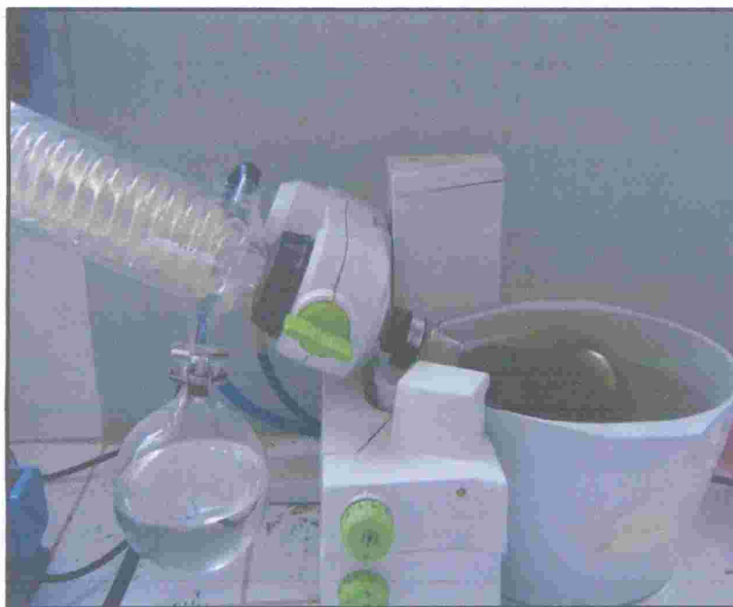
Figura 10. Concentración del extracto hidroalcohólico en el rotavapor.
