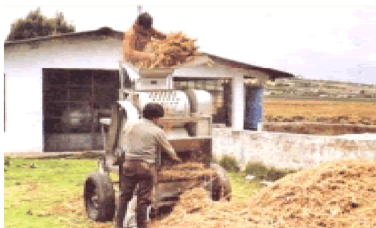
Figura 1.3. Trilladora estacionaria de cereales “PULLMAN” de fabricación americana, adaptada para la trilla de quinua.
