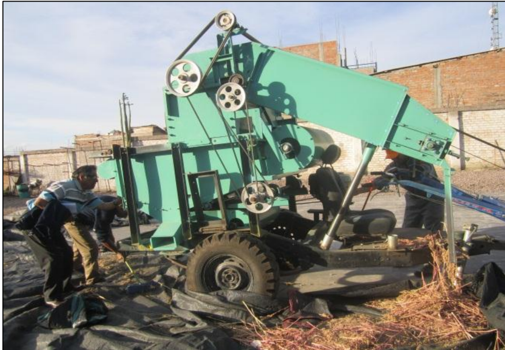
Foto 13. Pruebas finales de eficiencia y rendimiento de la trilladora prototipo
