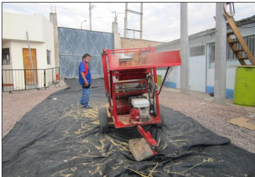
Foto 11. Trilladoras prototipo con baja eficiencia y rendimiento en trillado de quinua
