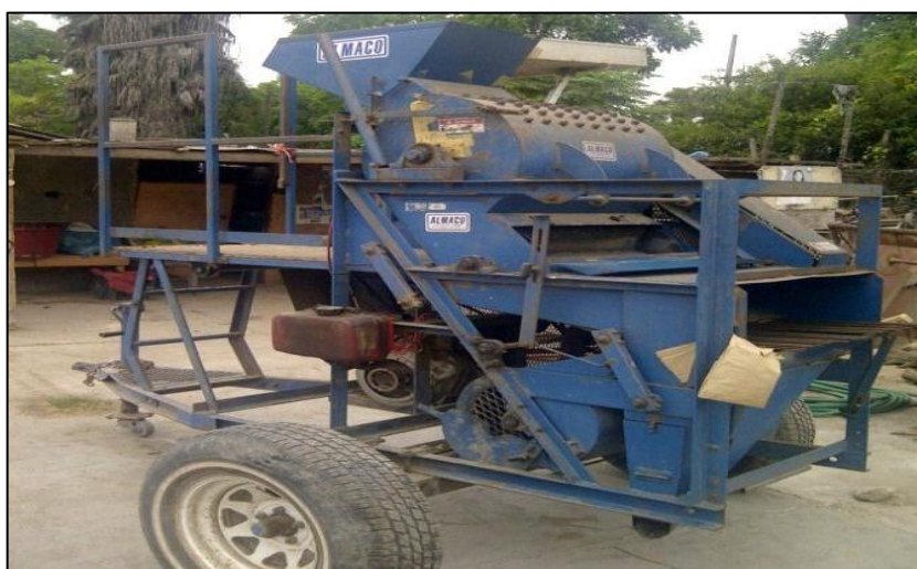
Figura 2.8. Trilladora venteadora MORITZ FRIEDRICH en Pedregal (Arequipa)
