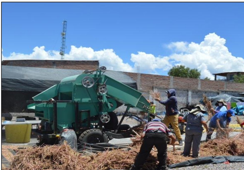
Foto 14. Pruebas finales de eficiencia y rendimiento de la trilladora prototipo
