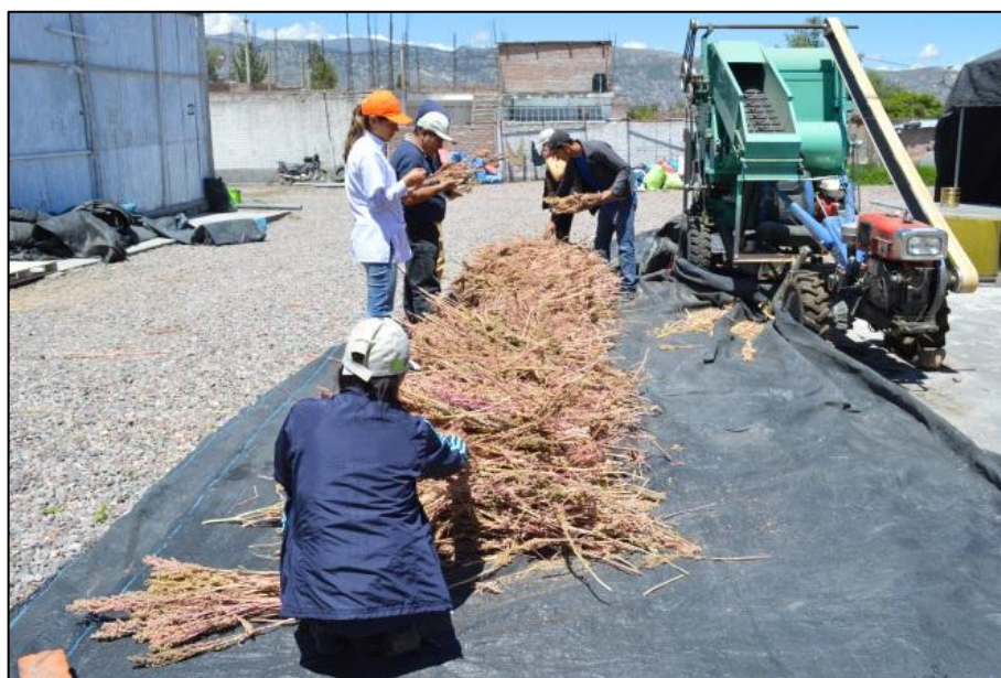
Figura 3.20. Evaluación de eficiencia de la trilladora
