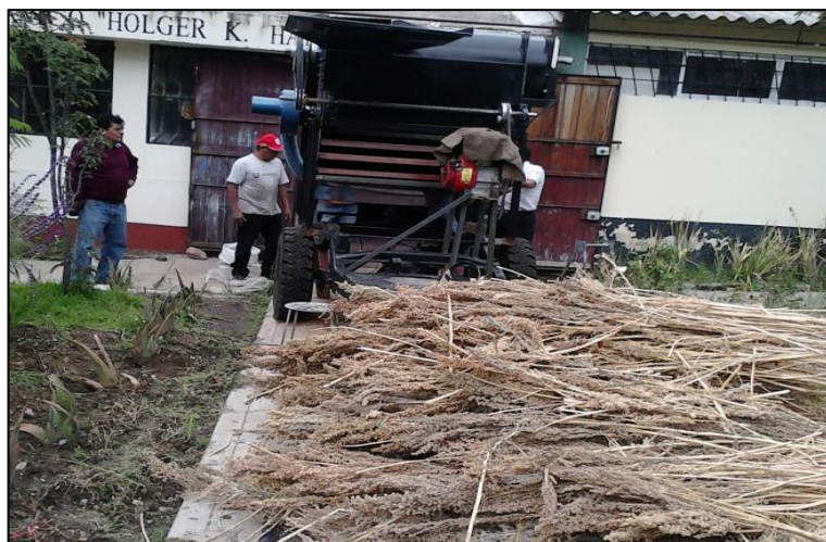
Figura 3.16. Primera prueba de trillado de panojas quinua
