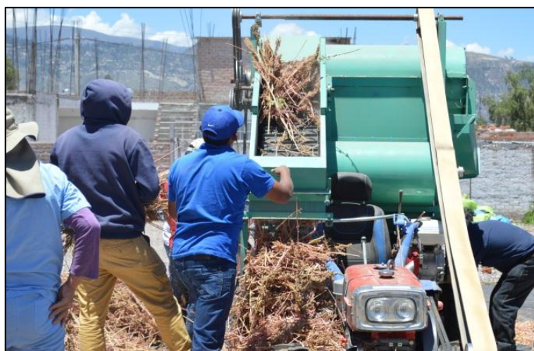
Figura 3.22. Evaluación de trilladora de panoja Roja Pasankalla
