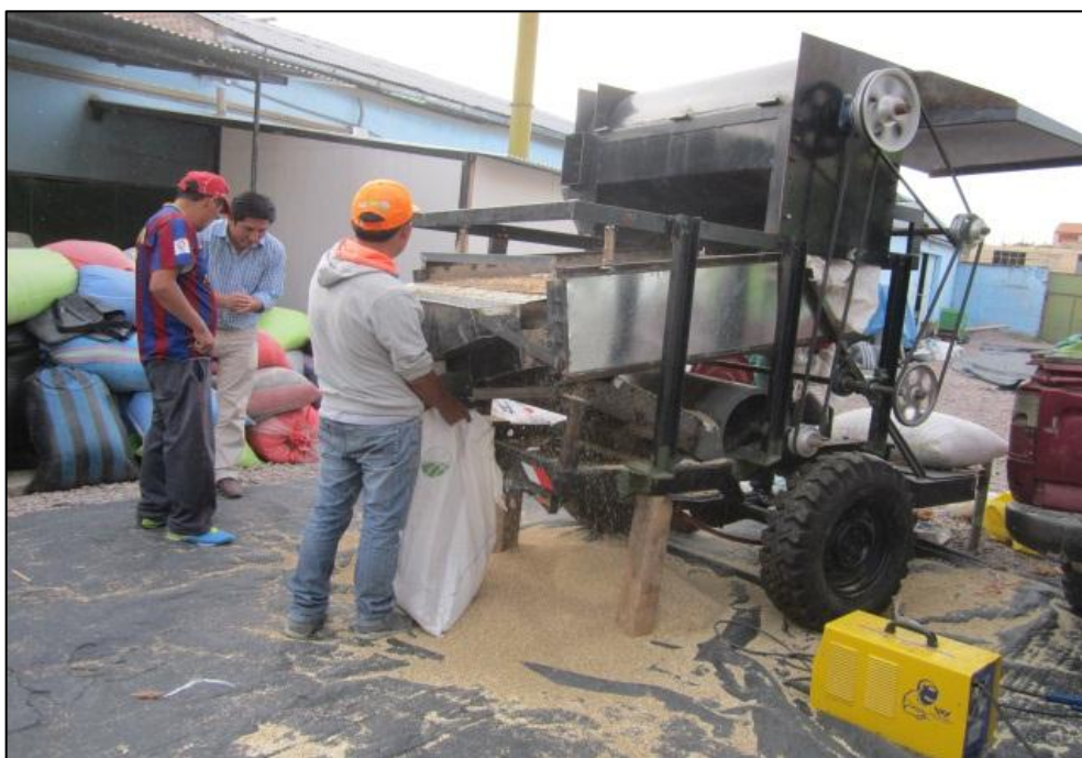
Foto 14. Pruebas preliminares de eficiencia y rendimiento de la trilladora prototipo
