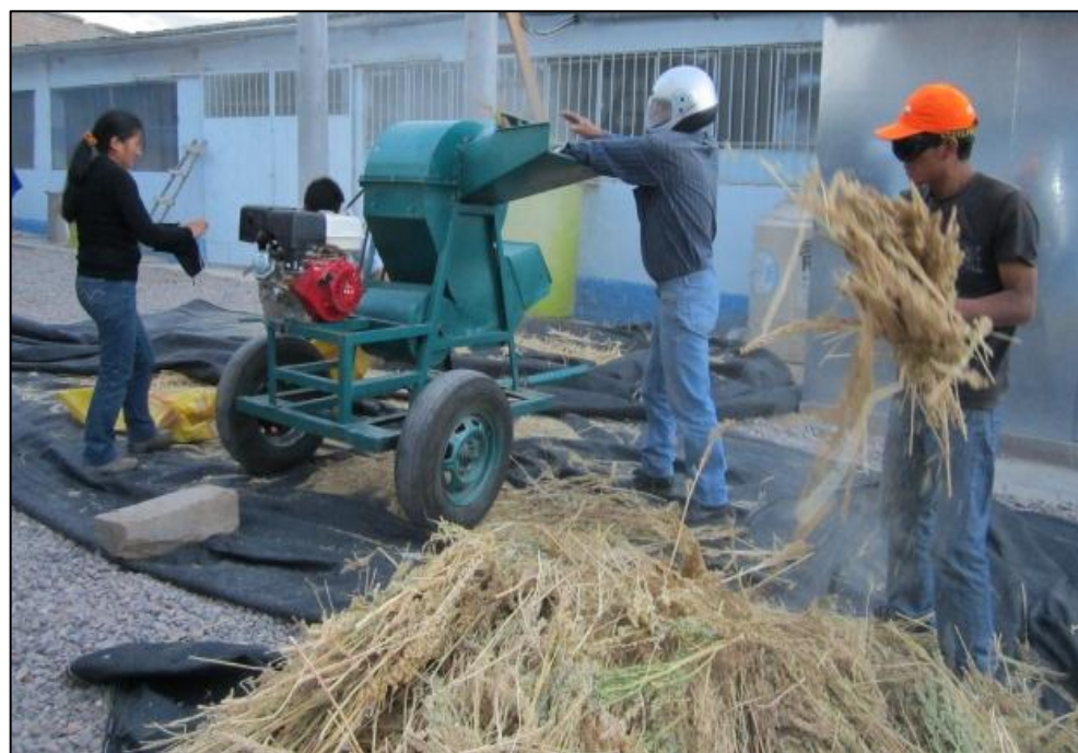
Foto 12. Trilladoras prototipo con baja eficiencia y rendimiento en trillado de quinua
