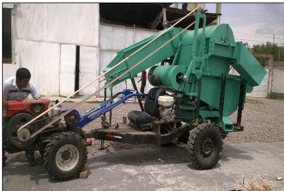
Figura 3.14. Sistema de trillado acoplado al motocultor
