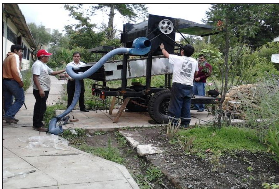
Figura 3.15. Ensamblaje de componentes de la trilladora
