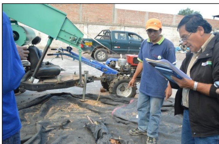
Figura 3.23. Evaluación de trilladora de panoja Blanca de Junín
