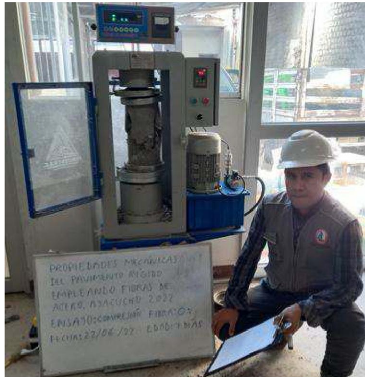
Figura B.11 Rotura a la compresión de los testigos de concreto en prensa hidráulica, sin fibra, edad 7 días.
