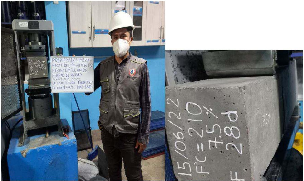
Figura B.19 Rotura a la flexión de los testigos de concreto en prensa hidráulica, fibra 7.5 % del peso de cemento, edad 28 días
