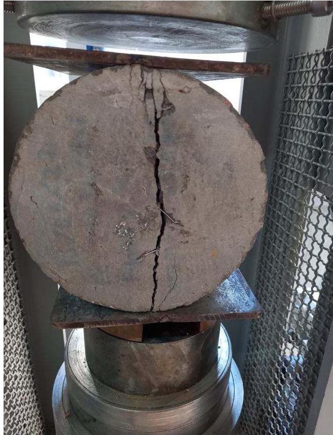
Figura B.23 Rotura a la tracción de los testigos de concreto en prensa hidráulica, fibra 7.5 % del peso de cemento, edad 28 días Fuente: Elaboración propia
