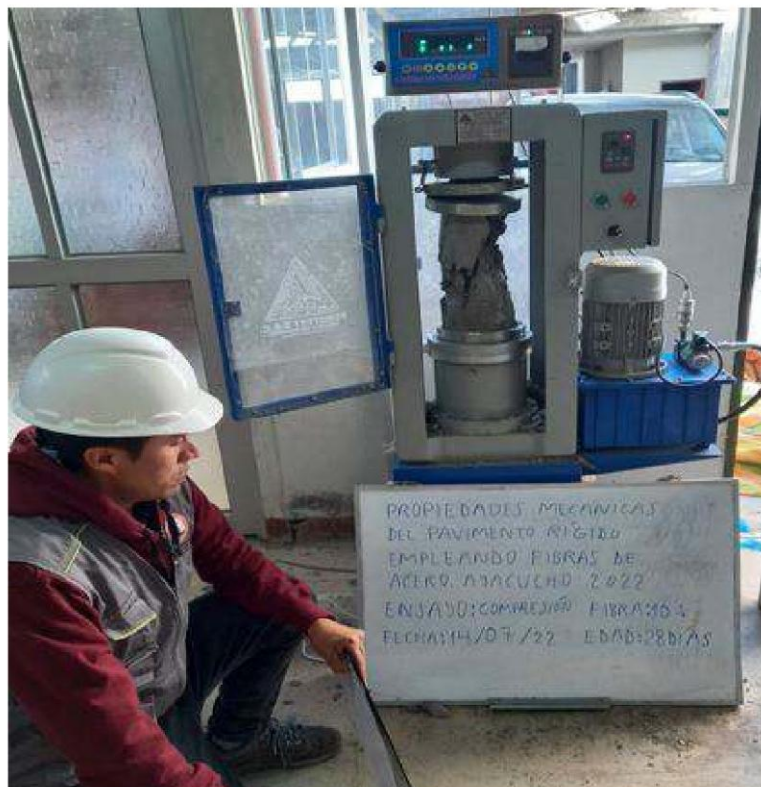
Figura B.16 Rotura a la compresión de los testigos de concreto en prensa hidráulica, fibra 10 % del peso de cemento, edad 28 días
