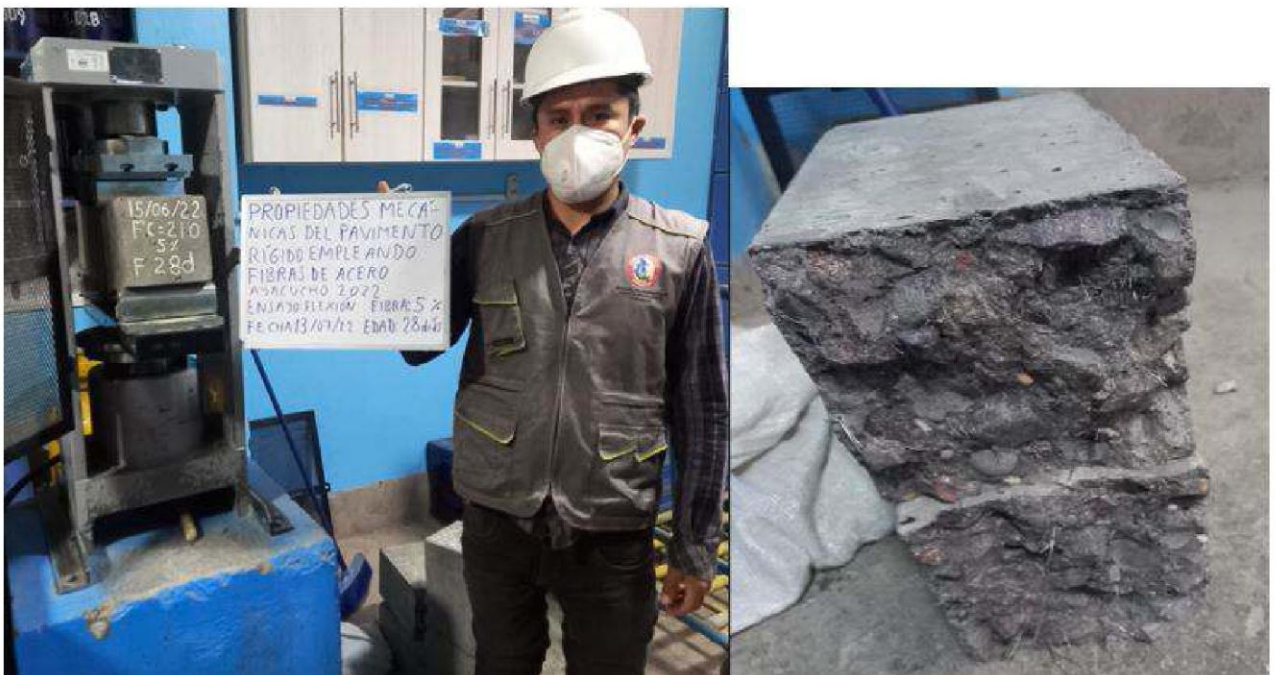
Figura B.18 Rotura a la flexión de los testigos de concreto en prensa hidráulica, fibra 5 % del peso de cemento, edad 28 días
