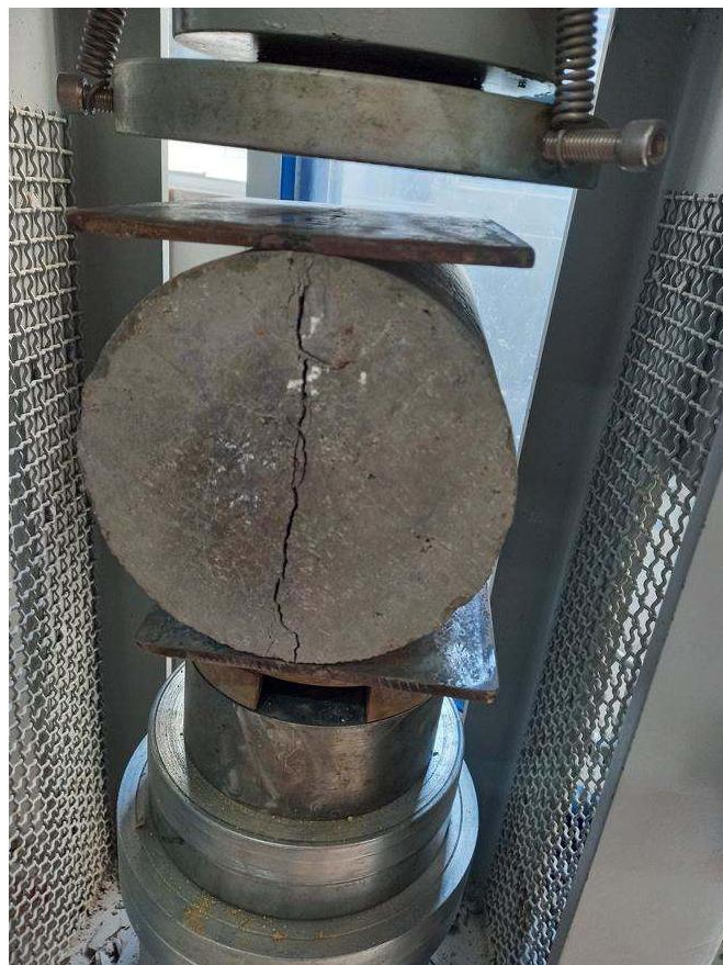
Figura B.22 Rotura a la tracción de los testigos de concreto en prensa hidráulica, fibra 5 % del peso de cemento, edad 28 días
