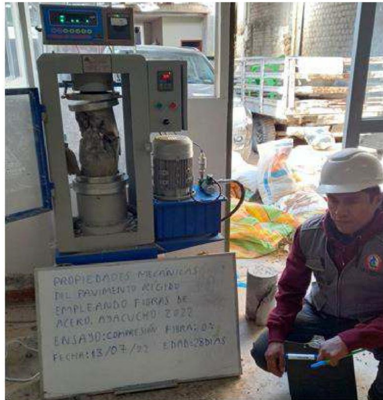
Figura B.13 Rotura a la compresión de los testigos de concreto en prensa hidráulica, sin fibra, edad 28 días.
