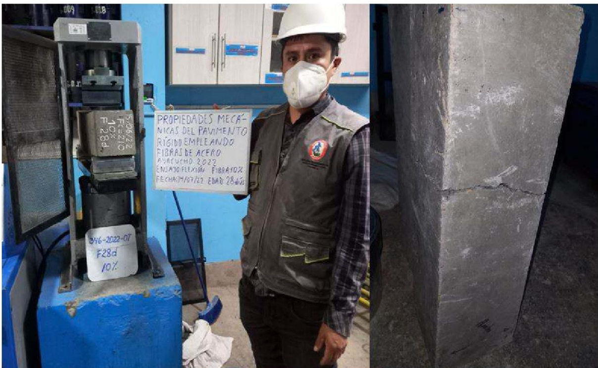
Figura B.20 Rotura a la flexión de los testigos de concreto en prensa hidráulica, fibra 10 % del peso de cemento, edad 28 días
