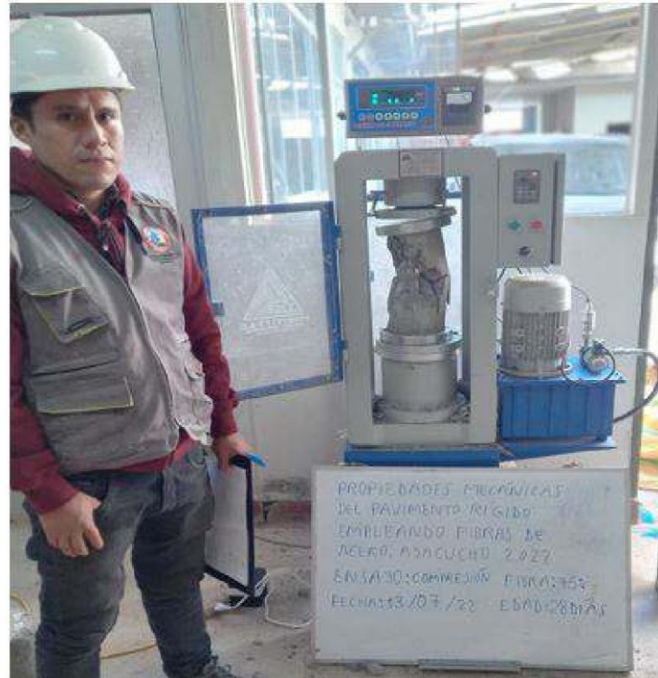
Figura B.15 Rotura a la compresión de los testigos de concreto en prensa hidráulica, fibra 7.5 % del peso de cemento, edad 28 días
