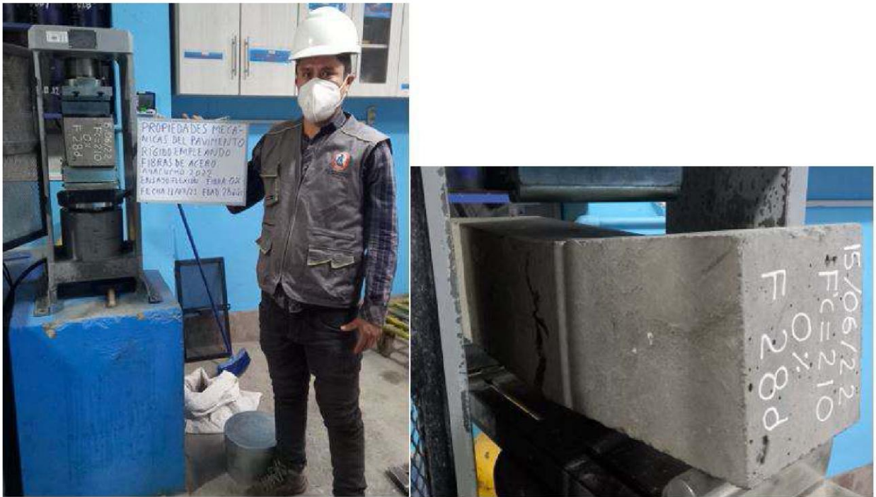
Figura B.17 Rotura a la flexión de los testigos de concreto en prensa hidráulica, sin fibra, edad 28 días
