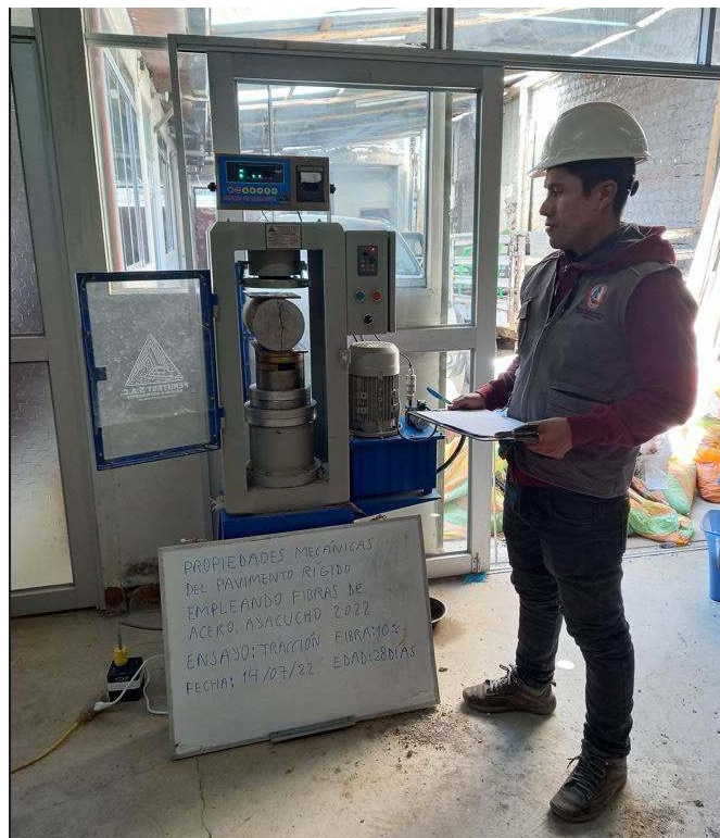
Figura B.24 Rotura a la tracción de los testigos de concreto en prensa hidráulica, fibra 10 % del peso de cemento, edad 28 días Fuente: Elaboración propia
