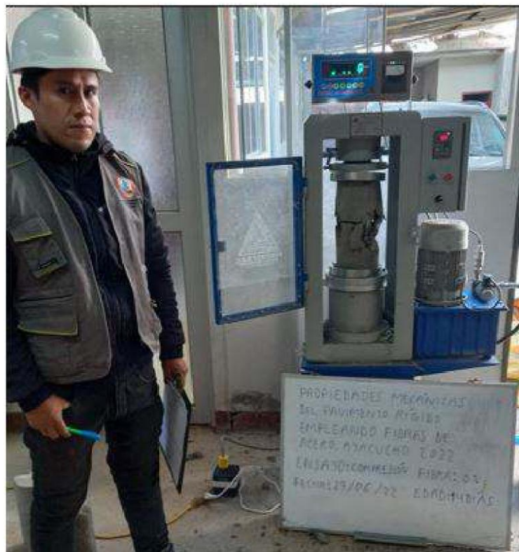
Figura B.12 Rotura a la compresión de los testigos de concreto en prensa hidráulica, sin fibra, edad 14 días.
