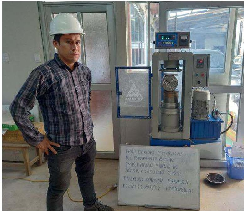
Figura B.21 Rotura a la tracción de los testigos de concreto en prensa hidráulica, sin fibra, edad 28 días
