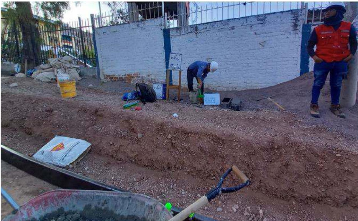
Figura B.10 Obtención de testigos de concreto adicionado con fibras de acero en 10 % respecto al peso de cemento.
