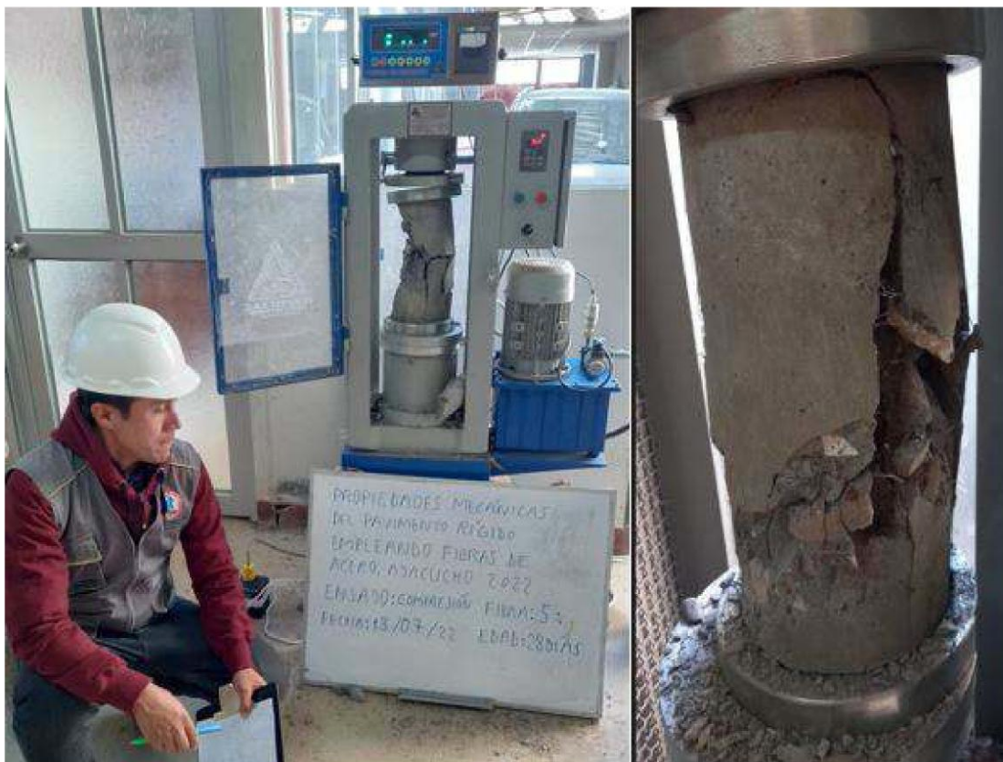
Figura B.14 Rotura a la compresión de los testigos de concreto en prensa hidráulica, fibra 5 % del peso de cemento, edad 28 días
