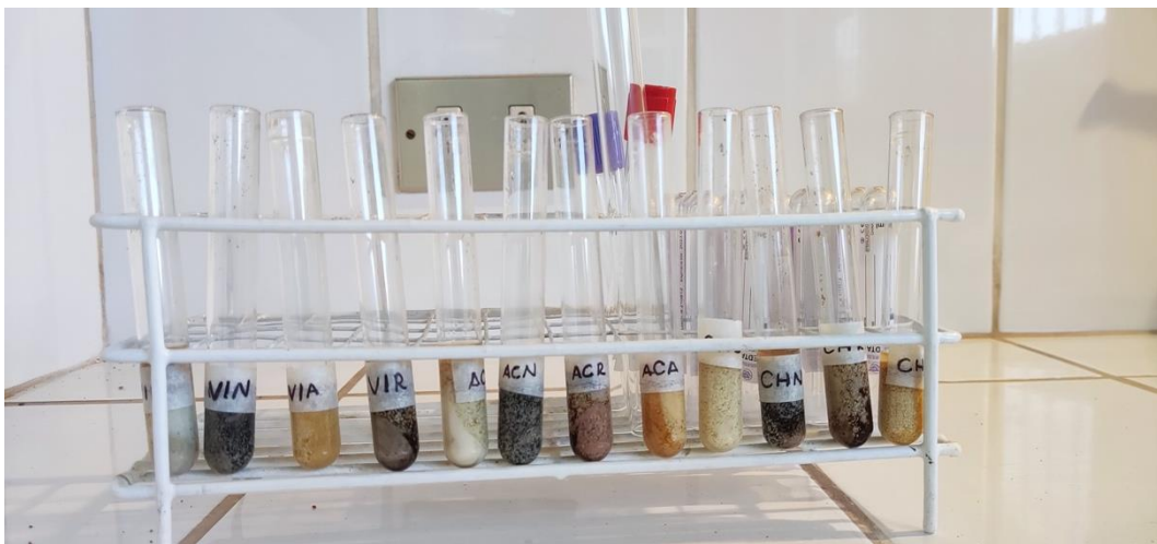
Muestras molidas de 4 accesiones de Chenopodium quinoa Willd "quinua" centrifugadas y en reposo por 24 horas para la total eliminación de N-hexano por evaporación.
