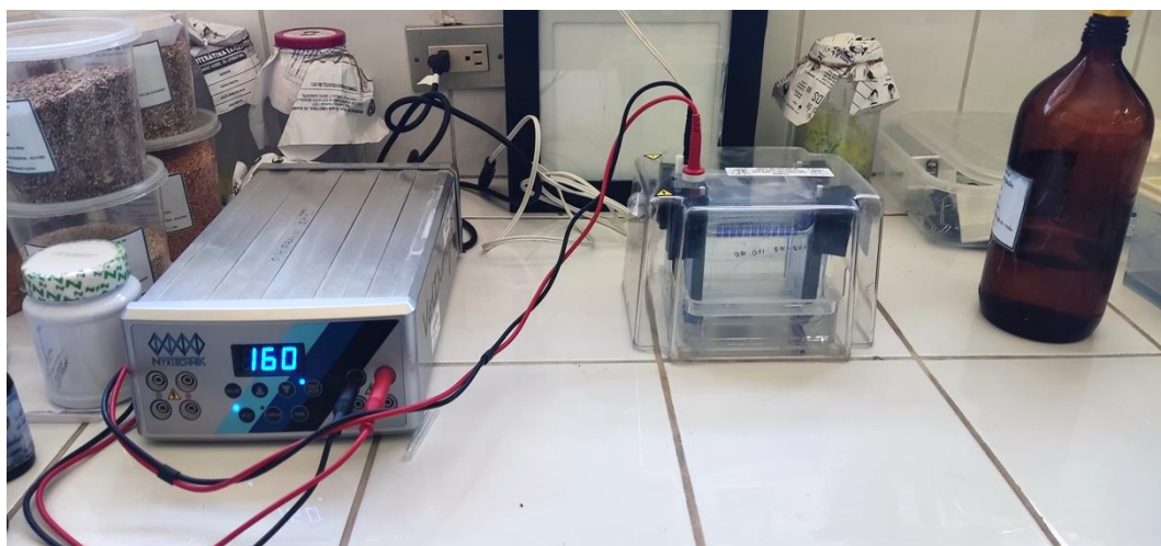
Equipos de electroforesis; fuente de poder, electrodos, cámara de corrida y transiluminador
