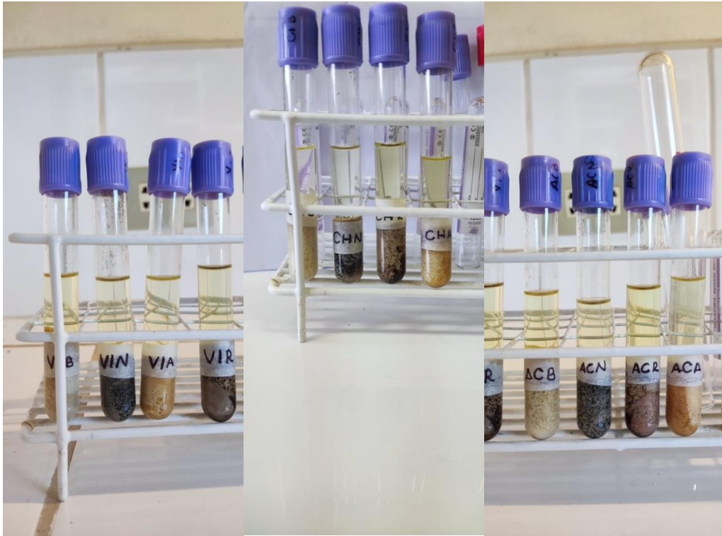
Muestras molidas de 4 accesiones de Chenopodium quinoa Willd "quinua" después de 24 horas de agitación constante a 100 rpm.
