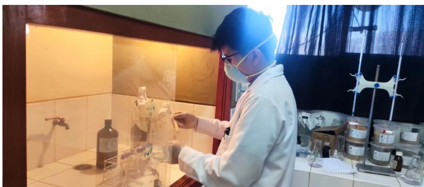
Tesista en proceso de extracción de lípidos con N-hexano en muestras molidas de 4 accesiones de Chenopodium quinoa Willd “quinua”
