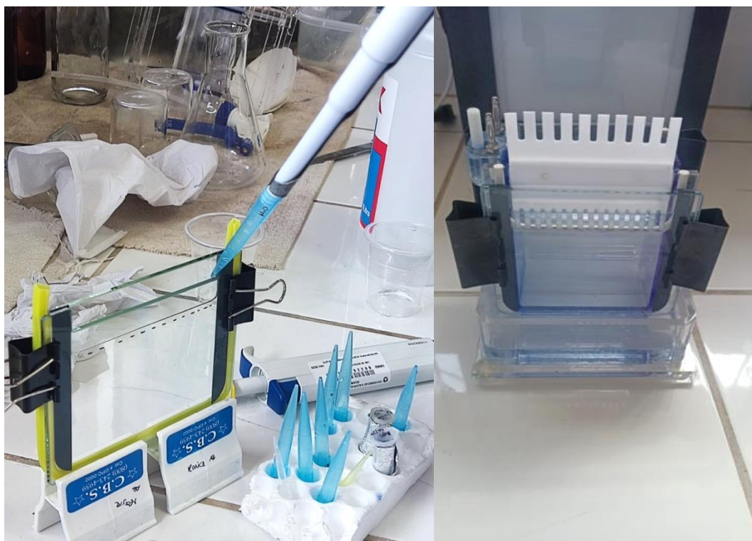
Armado de matrices de gel SDS-PAGE al 15 % (separador) y 5 % (concentrador).
