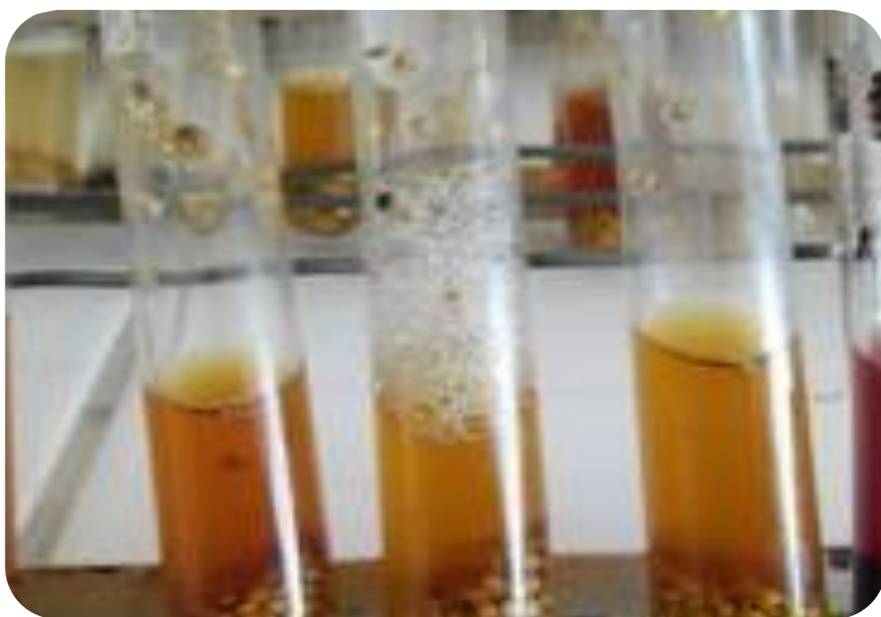
Foto 10. Cuantificación de la saponina de la quinua por el método de Espuma en LGBV-UNSCH
