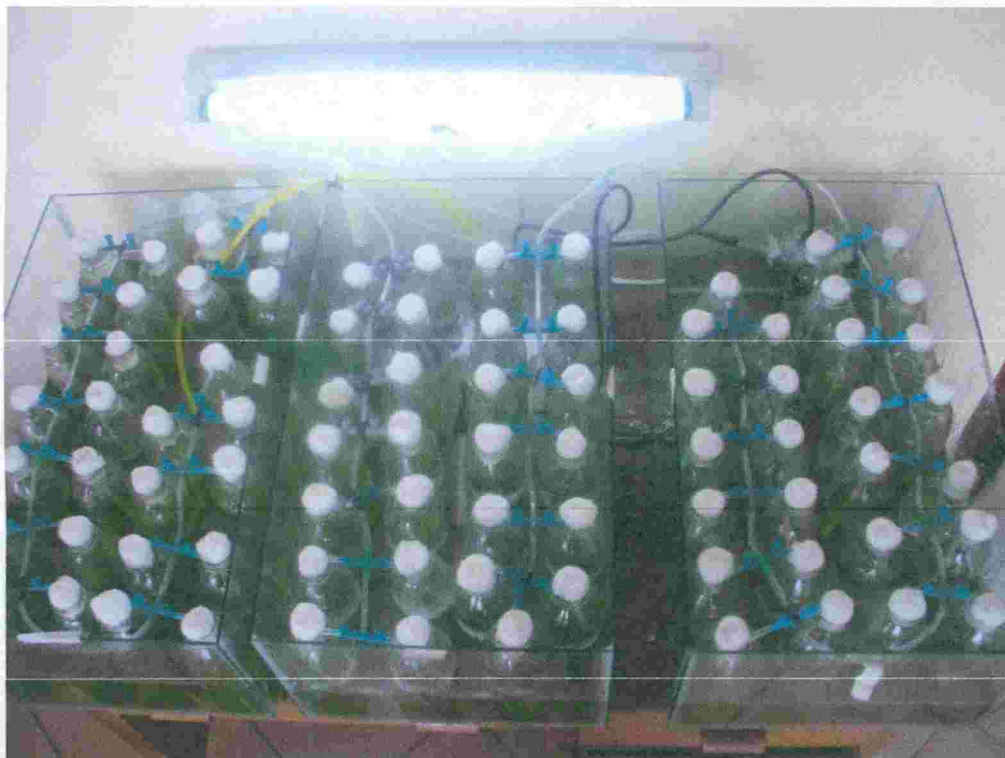
Fotografía N°04: Equipo completamente instalado para la obtención de la biomasa con los distintos parámetros.
