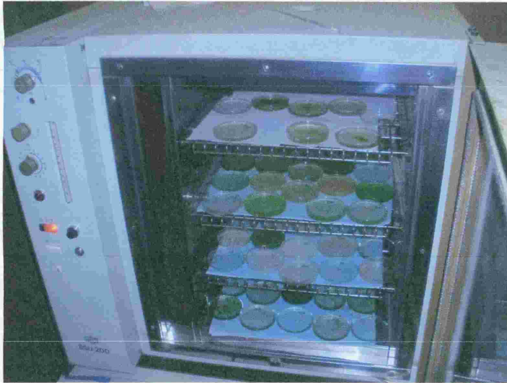
Fotografía N°05: Placas de Petri en la estufa a una temperatura de 60 °C por 24 horas.
