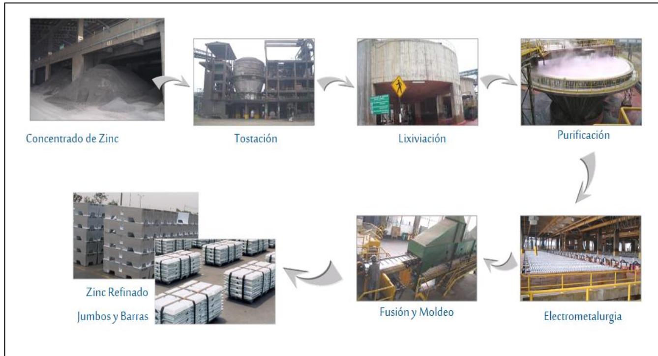
Figura 1.3 Flujo del proceso productivo de la Refinería Cajamarquilla
