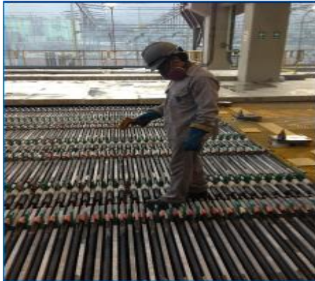
Figura 3.3: Medición de temperatura con pirómetro Fuente: Propia
