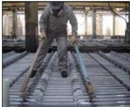
Figura 6.16: Operador alineando electrodos Fuente: Propia
