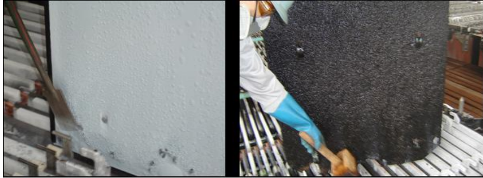
Figura 6.15: Corrección de cortocircuito Fuente: Propia
