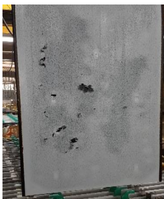
Figura 6.7: Cortocircuito por crecimiento de bióxido en el ánodo Fuente: Propia
