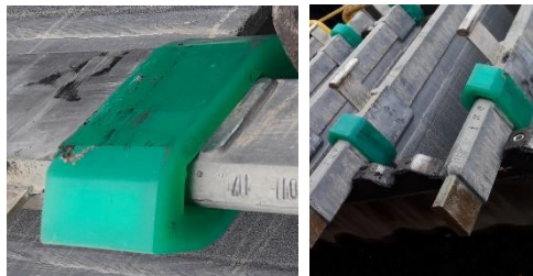
Figura 6.28: Separador de cabezal de ánodo
