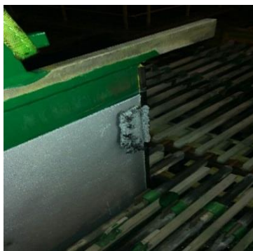
Figura 6.1: Cortocircuito por depósito excesivo en lámina de zinc Fuente: Propia
