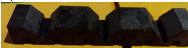
Figura 6.25: Soporte de cabezal de ánodo Fuente: Propia
