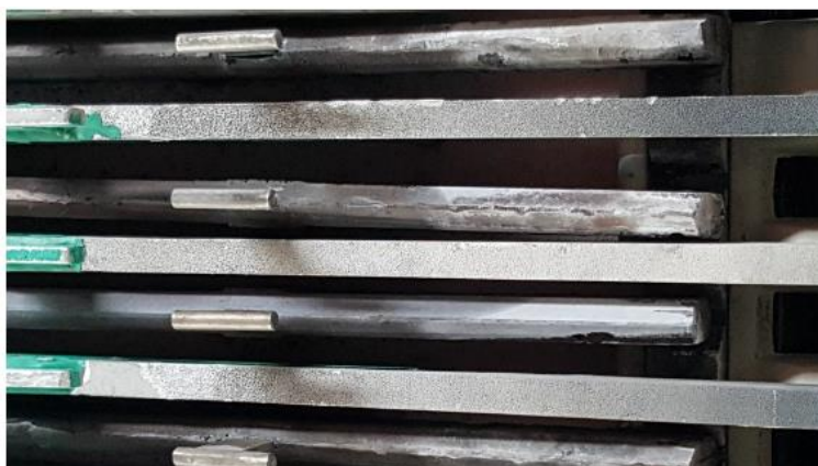
Figura 6.11: Electrodo desalineados Fuente: Propia
