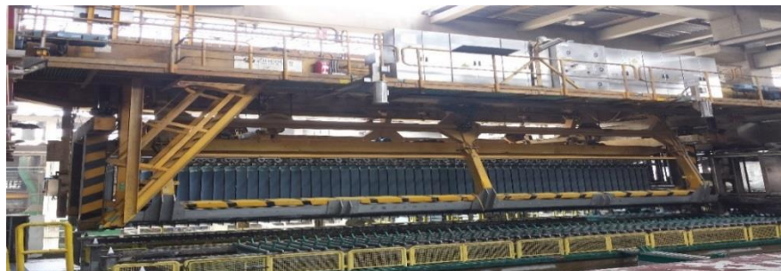
Figura 4.2: Grúa con carga de cátodos
