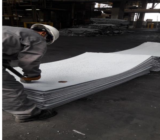
Figura 6.31: Muestreo de láminas de zinc Fuente: Propia
