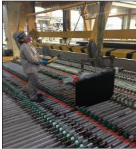
Figura 6.14: Izamiento de ánodo Fuente: Propia
