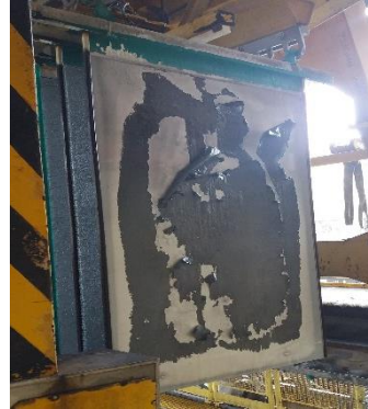
Figura 6.2: Cortocircuito por desgaste de contacto de cátodo Fuente: Propia
