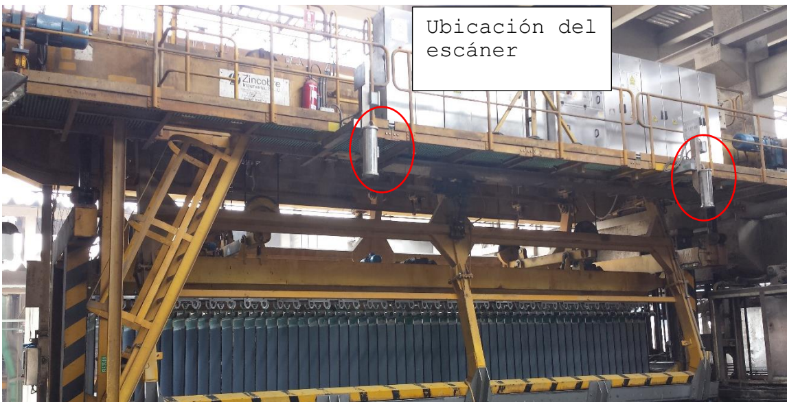
Figura 3.5: Ubicación del escáner en la grúa de cátodos
