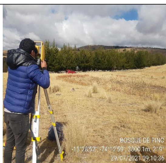
Foto 12: Levantamiento topográfico del Bosque con Estación Total y con Dron phantom.
