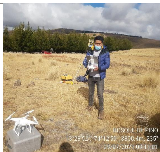
Foto 16: Levantamiento topográfico con Dron (Phantom pro 4) para la fotogrametría.
