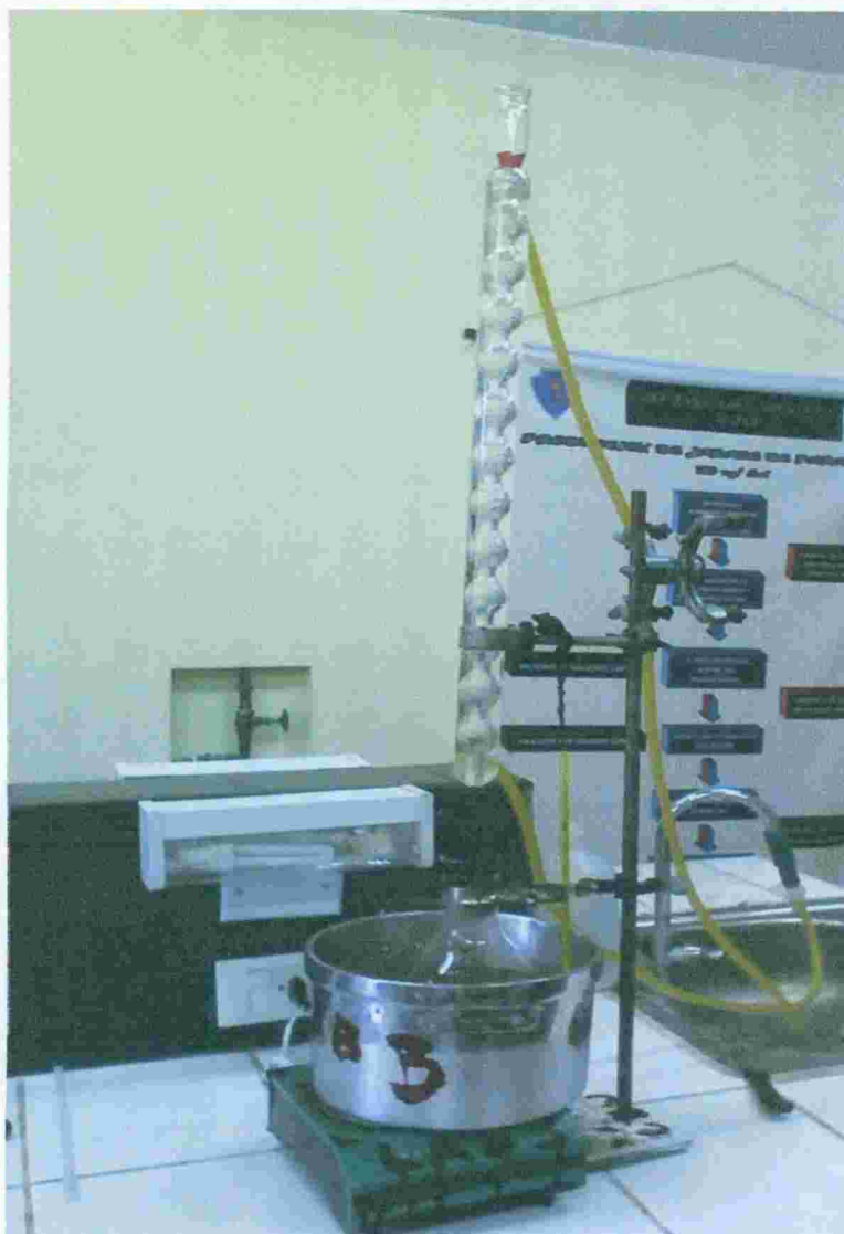
Fotografía 4: Equipo utilizado para la obtención de quitosano por método químico. Proceso de desacetilación de la quitina obtenida de los exoesqueletos de “cangrejos” Cancer spp. Ayacucho, 2010.
