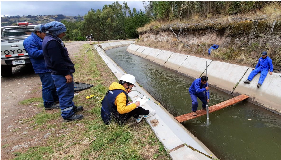
Figura 32 Medición de la velocidad en un punto de la sección del canal Fuente: Elaboración propia
