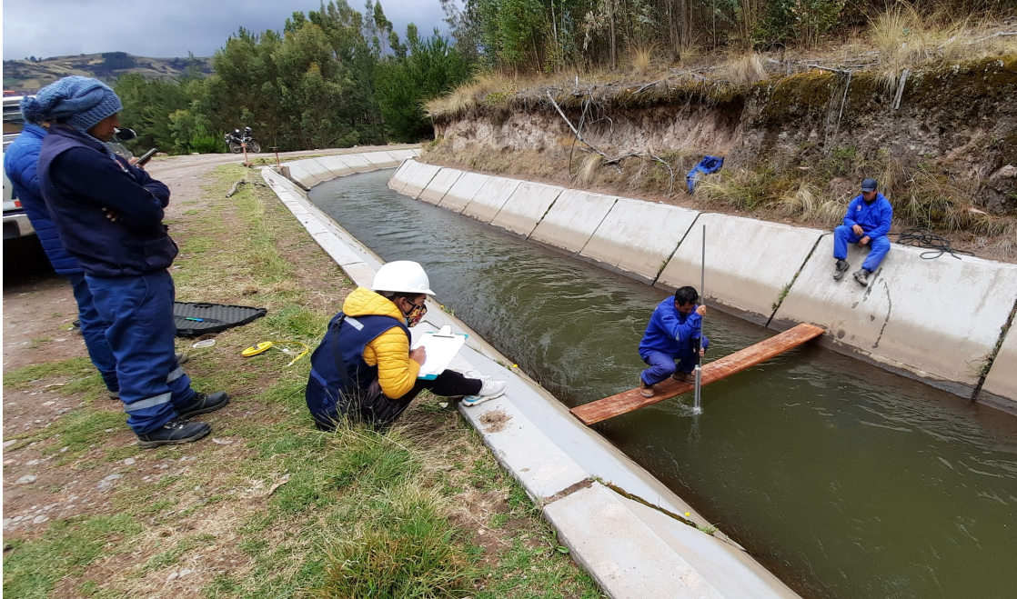
Figura 33 Medición de la velocidad en la sección del canal
