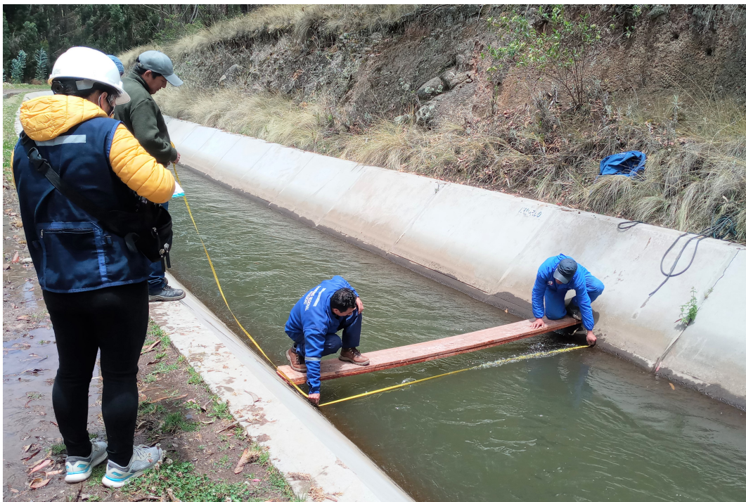
Figura 24 Medición del espejo de agua en el canal Fuente: Elaboración propia
