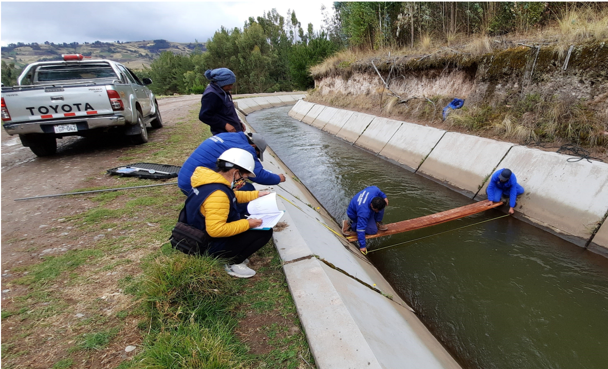
Figura 30 Medición del espejo de agua en el canal Fuente: Elaboración propia
