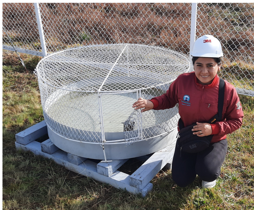
Figura 2 Evaporímetro clase A en la estación meteorológica de Allpachacca
