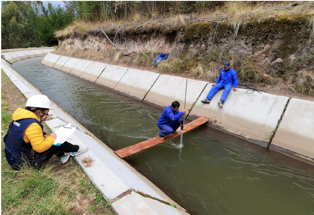
Figura 31 Medición del tirante de la sección del canal Fuente: Elaboración propia
