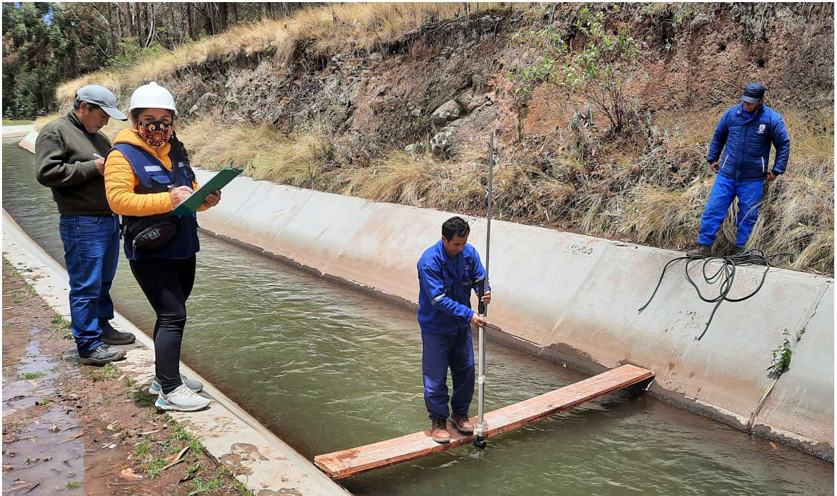
Figura 27 Medición de la velocidad en un punto de la sección del canal Fuente: Elaboración propia
