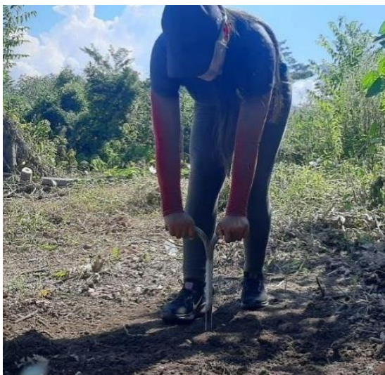
FOTO 1: Recojo de muestra de suelo con barreno manual. FECHA: 01/07/2023
