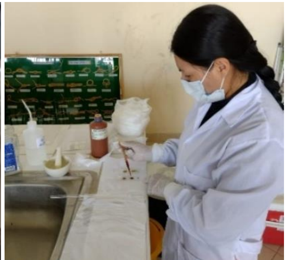
Foto 13. Colocar la muestra en la lamina + lugol
