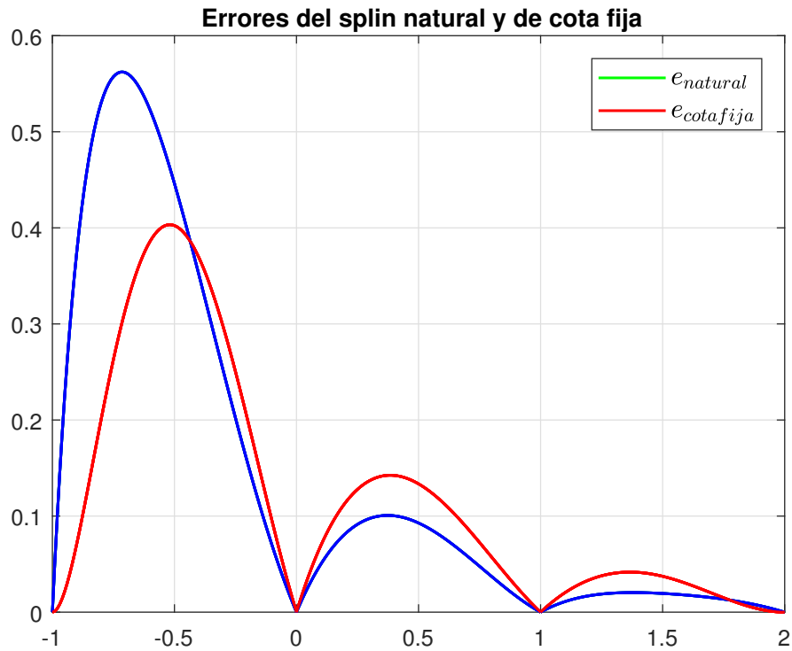
Figura 2.6. Gráfica que muestra el error al aproximar f(x) con ambos splines cúbicos.
