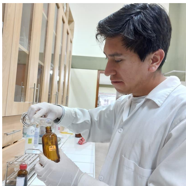
Fotografía N°12. Preparación de BSA con agua destilada y almacenado en frasco oscuro.
