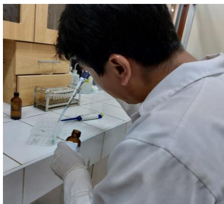
Fotografía N°19. Preparación de la muestra con el reactivo Bradford.
