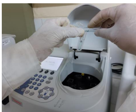
Fotografía N°22. Disposición de las muestras de trabajo en el equipo espectrofotómetro para su lectura.
