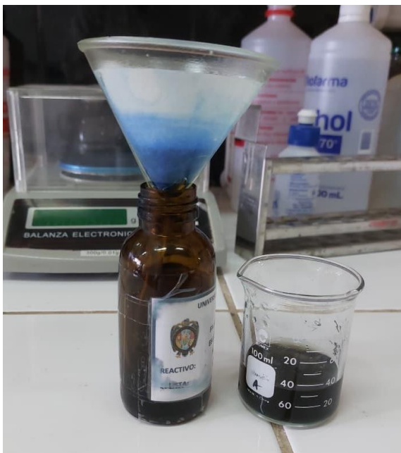
Fotografía N°8. Filtración de reactivo Bradford en frasco oscuro para evitar la exposición de luz.
