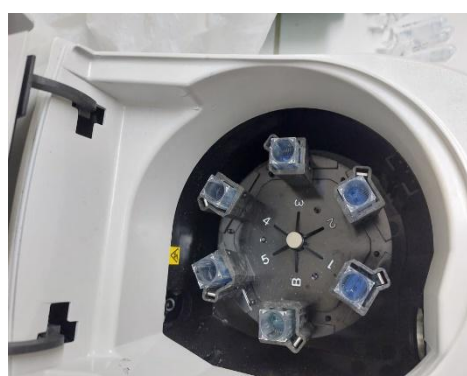
Fotografía N°23. Lectura de las muestras en espectrofotómetro a 595 nm.
