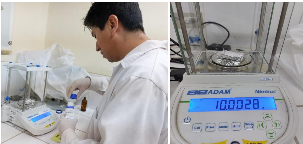
Fotografía N°10 y 11. Proceso de pesaje de reactivo BSA en balanza digital.
