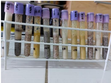
Fotografía N°15. Harina de quinua con reactivo para la extracción de proteínas.
