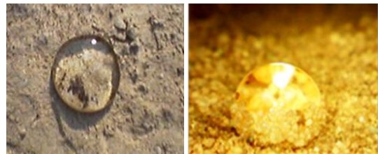
Aspecto de gotas de agua depositadas sobre suelos tratados con TerraSil. Como se puede observar, la repelencia de la gota es total.
