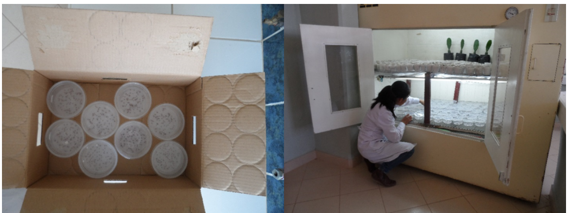
Figura A.8: Distribución de los tratamientos en la fase de producción de germinados. Izquierda: en cajas de cartón para generar condiciones de oscuridad continua. Derecha: en biotrón para generar condiciones de 12 horas luz-12 horas oscuridad.
