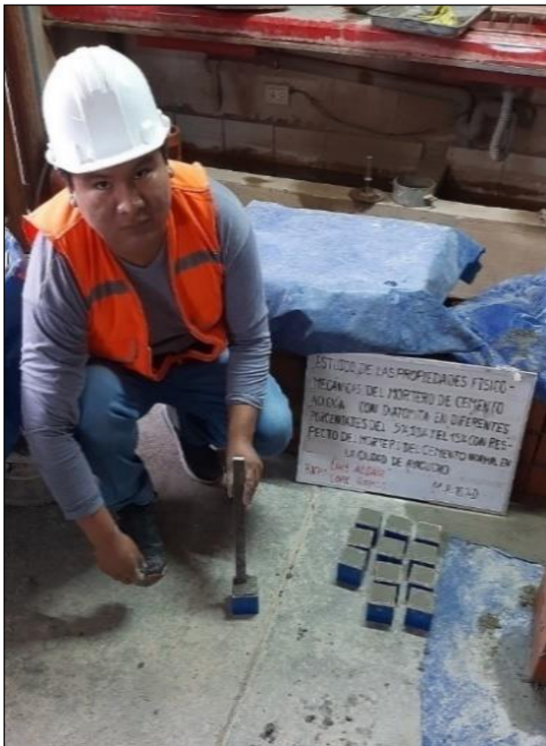
Figura 16 Preparación de especímenes cúbicos de mortero para ensayo.
