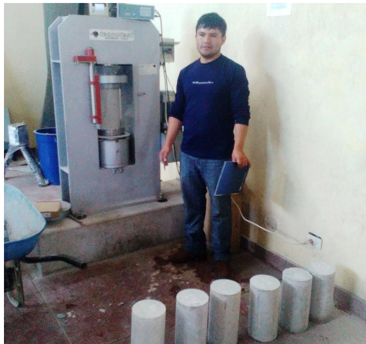
Figura C.4: Vista de los especímenes de concreto acondicionadas y listas para su ruptura.
