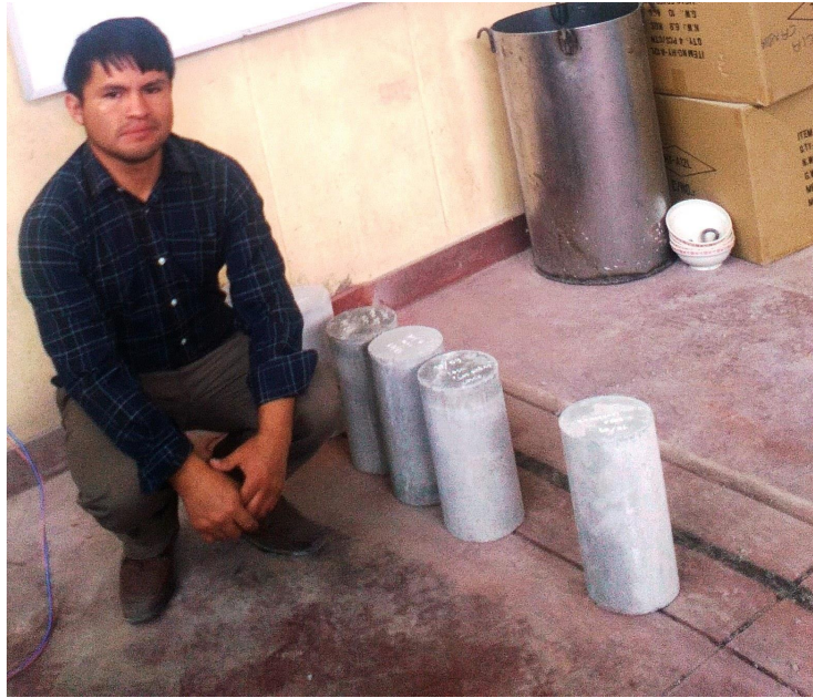
Figura C.5: Detalle de algunos especímenes de concreto para su posterior ruptura en el laboratorio de la E.P. de Ingeniería Civil - UNSCH.
