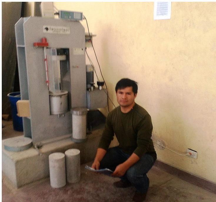
Figura C.6: Fotografía del equipo en plena ruptura de los especímenes de concreto.
