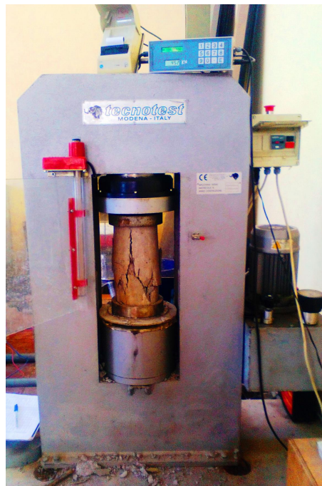
Figura 3.1: Equipo de ruptura de probetas de concreto marca Tecnotest.
