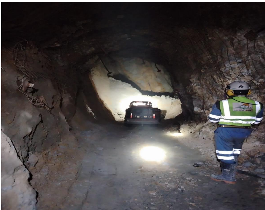
Foto 4: Acarreo de mineral roto con ayuda de telemando (scoop de 2.2 yd).
