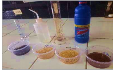
Desinfección con hipoclorito, lavado y desaponificación.
