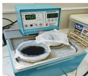
Evaporación del solvente a 45 °C
