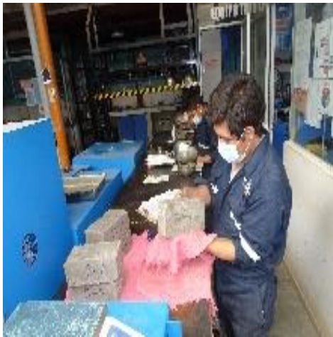
a) Secado de las unidades para obtener SSS
