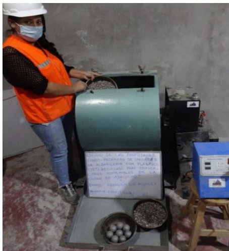
c) Muestra dentro de la Máquina de los Ángeles
