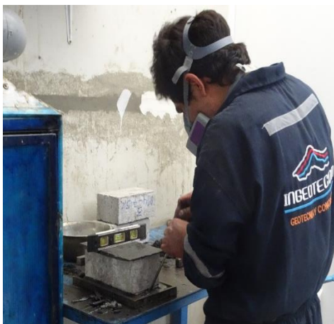
a) Desmolde del Capping
