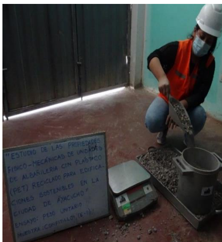
a) Aforado de la Muestra
