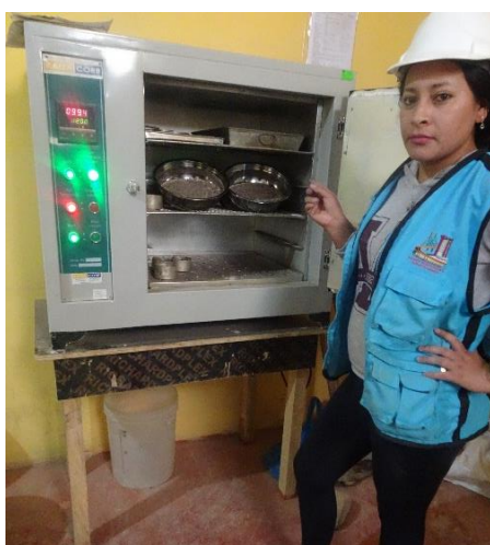
b) Secado de Muestra Durante 24 horas a una T° 110 °C.
