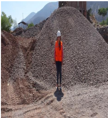
a) Agregado Grueso (confitillo)
