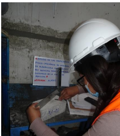
a) Medición del alabeo de la unidad de albañilería
