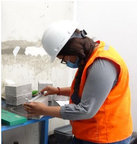
a) Medición de unidades de albañilería con vernier
