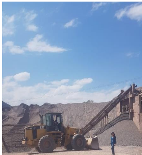
b) Zarandeado del agregado grueso
