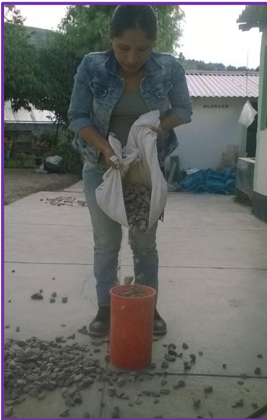
Figuras 3.12 y 3.13 Peso unitario suelto y varillado de la piedra chancada
