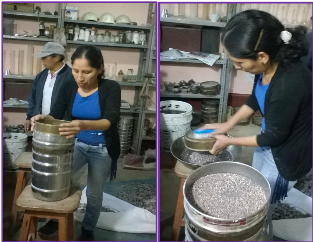
Figuras 3.21 y 3.22 Realizando el tamizaje del agregado fino con 20% de vidrio molido
