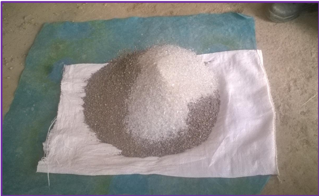
Figura 3.33 Mezclado de arena gruesa y vidrio molido de acuerdo a los resultados obtenidos
