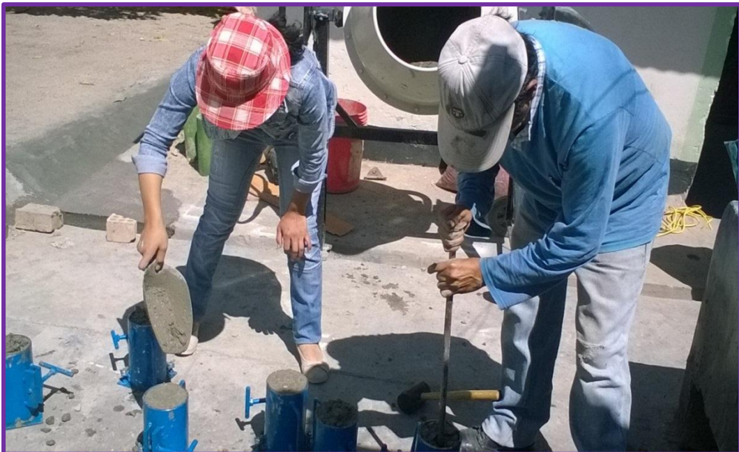
Figura 3.39 Llenado y chuceado de los moldes de concreto
