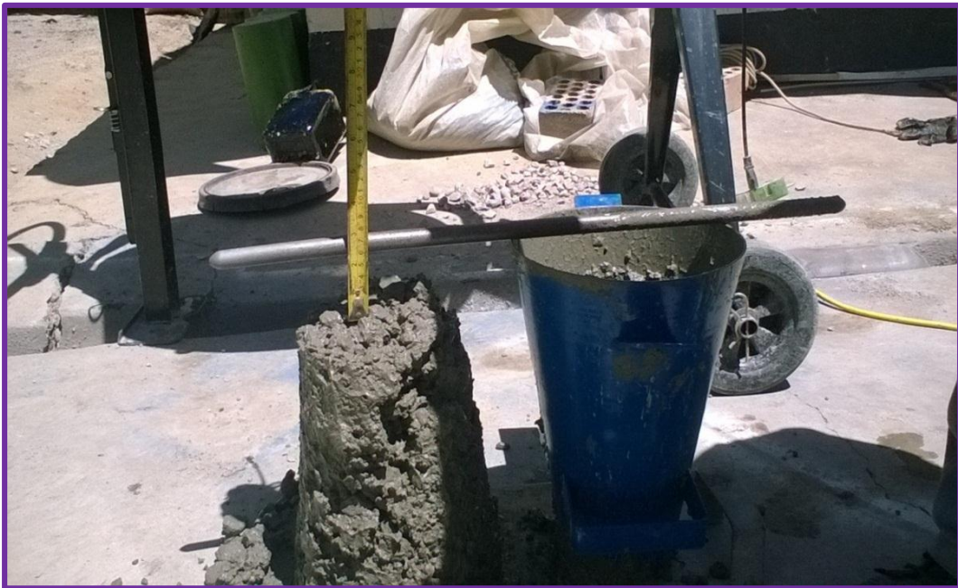
Figura 3.37 Midiendo el slump
