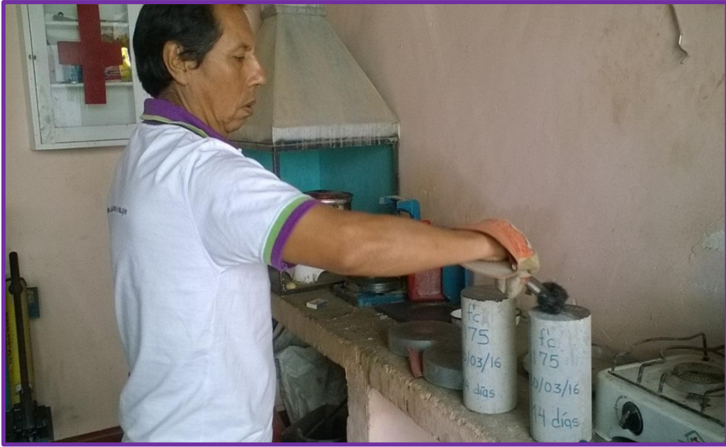
Figura 3.47 Aplicación de aceite para evitar el pegado del carpin en los moldes
