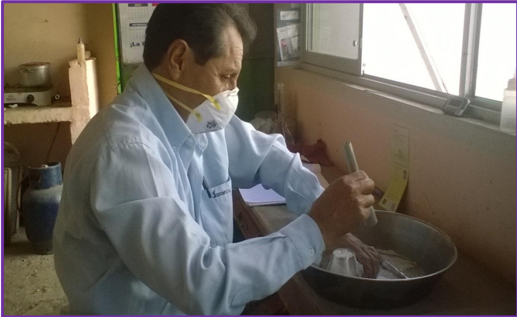
Figura 3.25 Apisonado del vidrio molido con el pisón metálico
