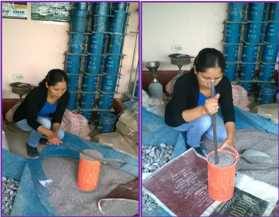
Figuras 3.9 y 3.10 Peso unitario suelto y varillado de la arena gruesa
