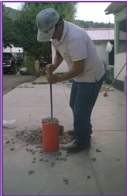
Figuras 3.12 y 3.13 Peso unitario suelto y varillado de la piedra chancada
