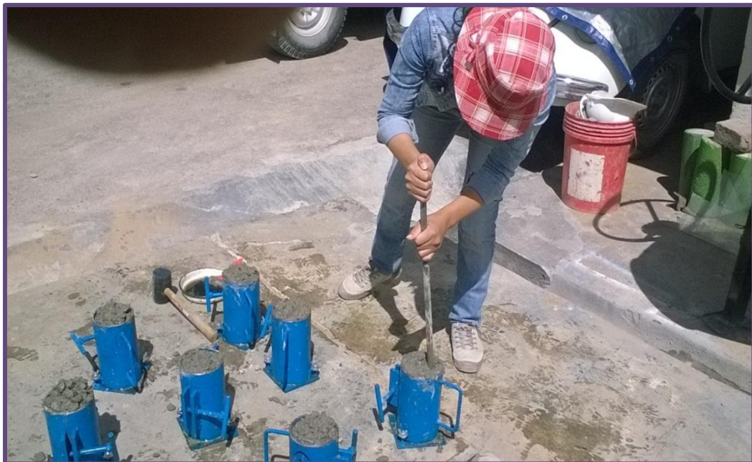
Figura 2.18 Realizando el compactado del concreto
