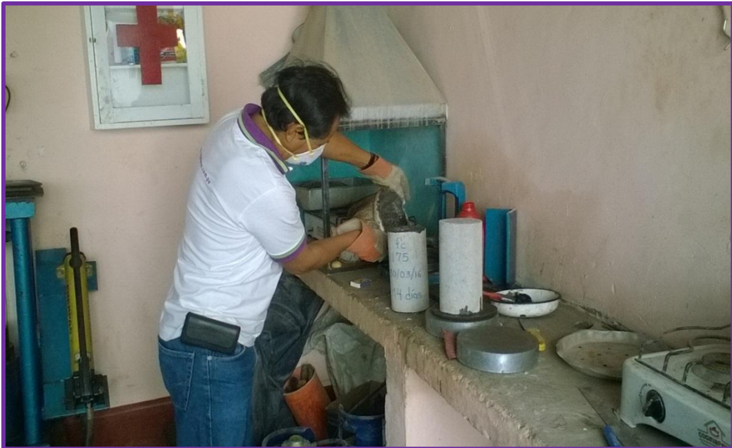
Figura 3.48 Colocado del azufre disuelto para conseguir una distribución uniforme de la carga
