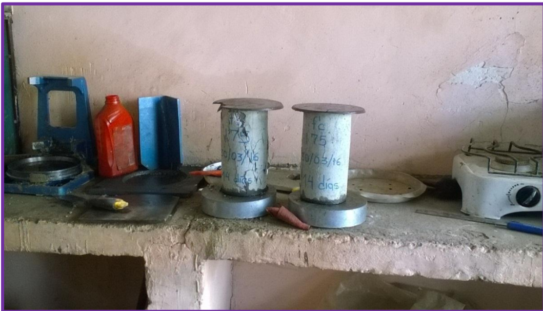
Figura 3.51 Resultado final de la rotura de los moldes
