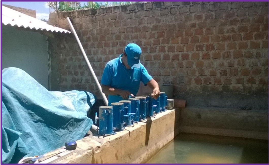
Figura 3.40 Raleado de los moldes
