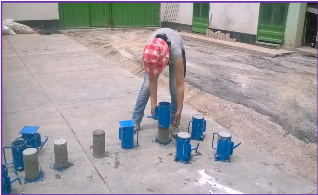
Figura 3.41 Desmolde de las probetas
