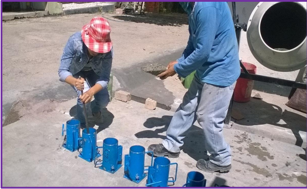
Figura 3.38 Llenado de los moldes con el concreto correspondiente de acuerdo a la dosificación
