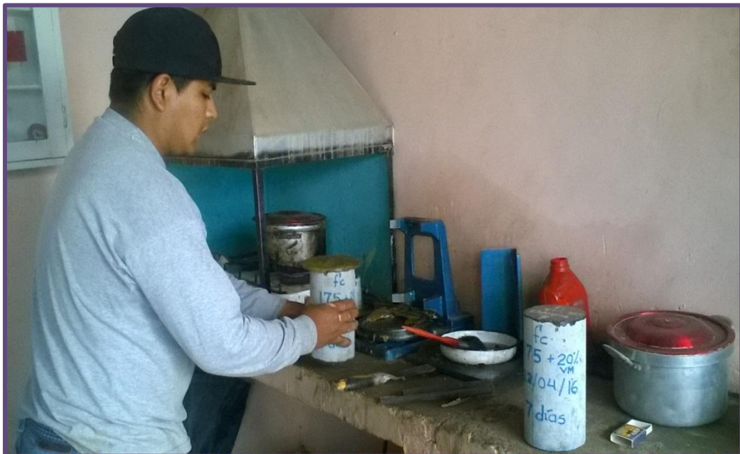
Figura 3.2 Refrentando con mortero de azufre
