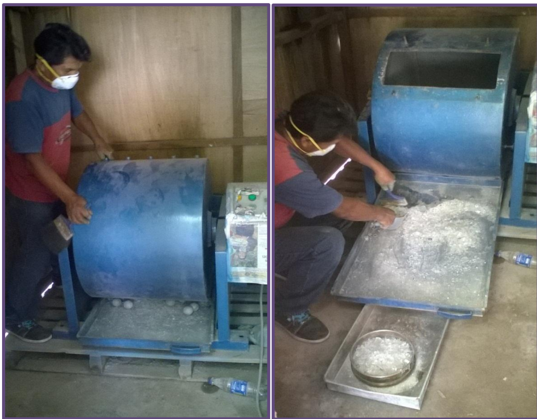
Figura 2.2 y 2.3 Molienda del vidrio en la máquina donde se realiza la prueba de Los Ángeles
