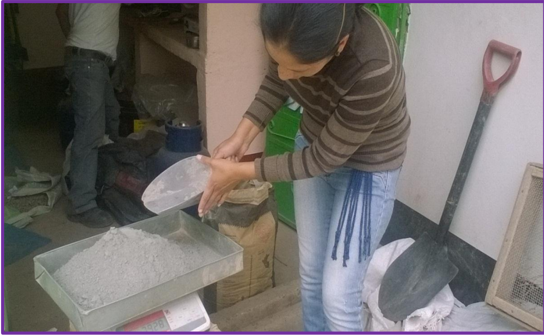
Figura 3.34 Pesando la cantidad de material necesario de acuerdo a la dosificación
