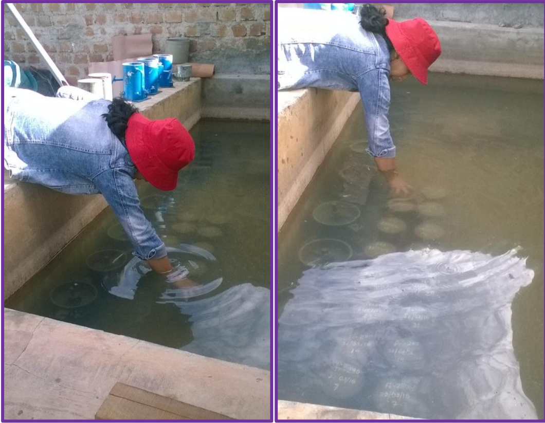
Figuras 3.44 y 3.45 Sumergido de los moldes en la poza para el curado respectivo
