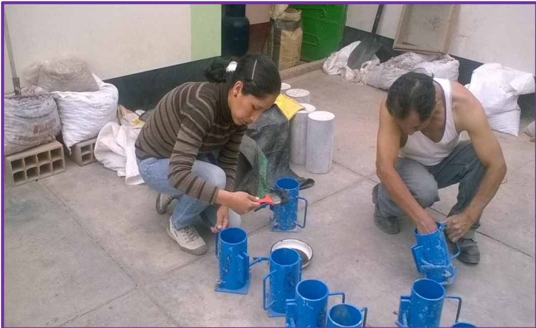
Figura 3.35 Engrasando los moldes para facilitar el desmolde
