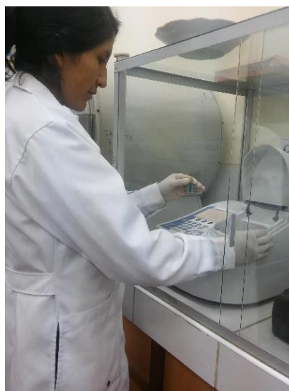
Después de reposar 30 minutos en la oscuridad se procedió a medir las absorbancias a 515 nm.
