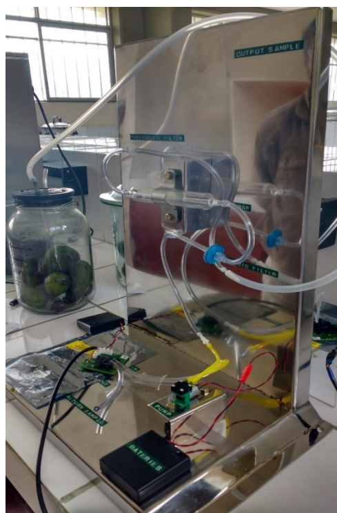
Figura 15. Panel de componentes: (cámara de respiración de 0.005m 3 , sensor de CO 2 , filtros de partículas e hidrofóbico, trampa de agua y bomba
