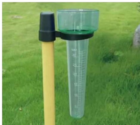
Figura 3 Pluviómetro para medir la precipitación
