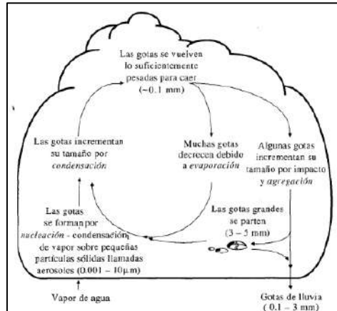
Figura 2 Proceso de formación de la precipitación.
