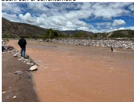
Figura 45 Aforo durante el tránsito de una máxima avenida del río Cachi con el correntómetro
