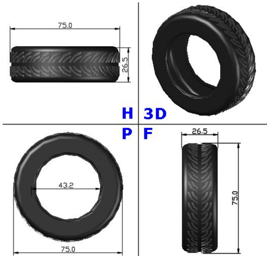
Figura III.12: Medidas de una unidad de NFU que se usará en el Proyecto
