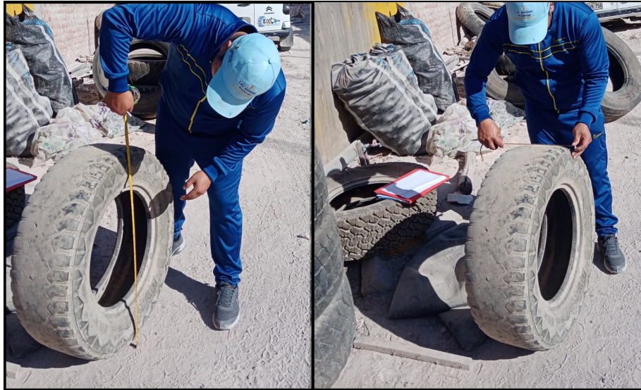
Figura III.11: Medición de Diametro (75 cm) y Espesor (26.5 cm) de un Neumatico Elegido al Azar
