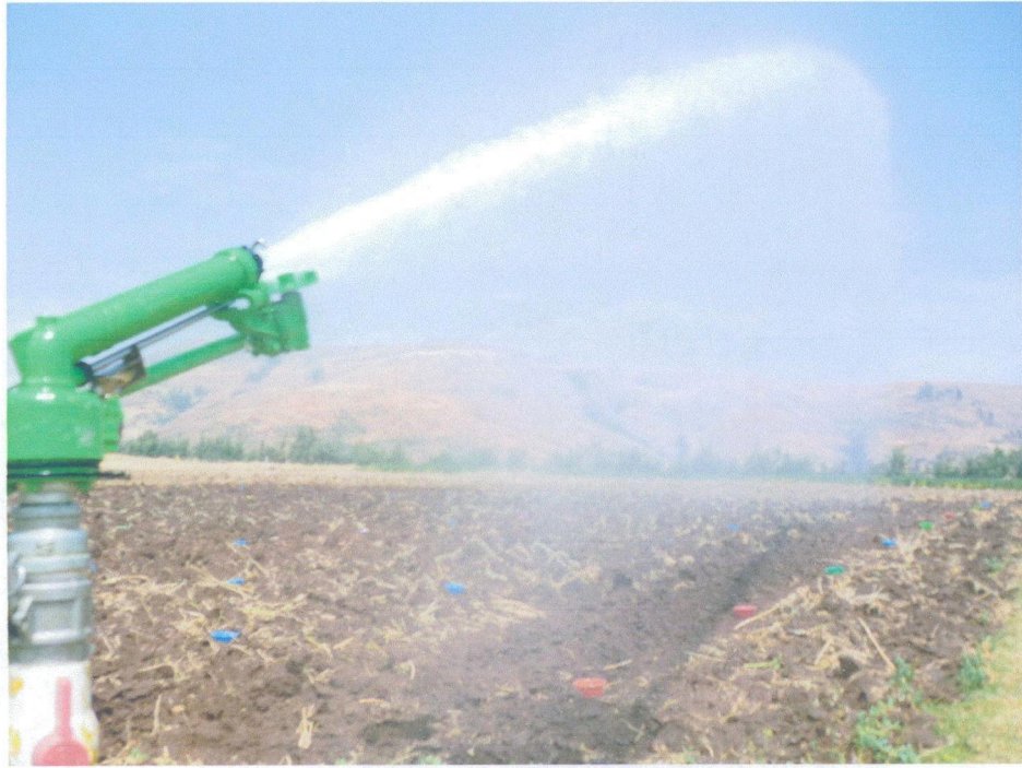
Fotografía N°05: Aspersor modelo skipper 1½" en funcionamiento – prueba de pluviometría en la comunidad de Llutacancha.
