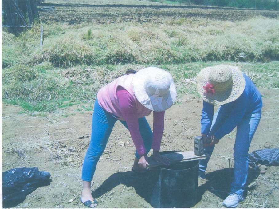
Fotografía N°11: Prueba de infiltración – en el predio que se realizó el ensayo de la comunidad de Uchuypampa.
