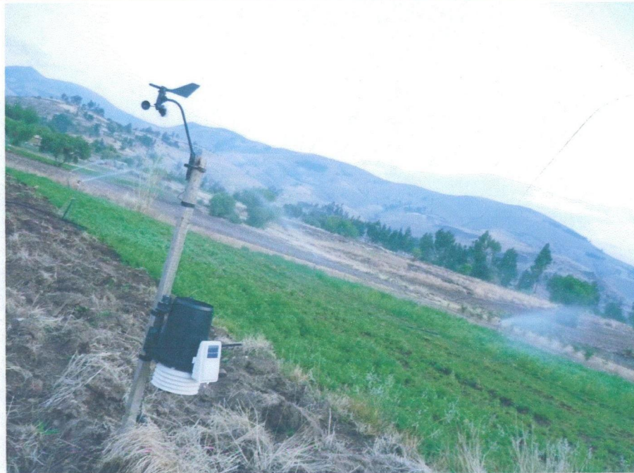
Fotografía N°10: Medida de parámetros climáticos con la estación meteorológica automática VANTAGE PRO 2.
