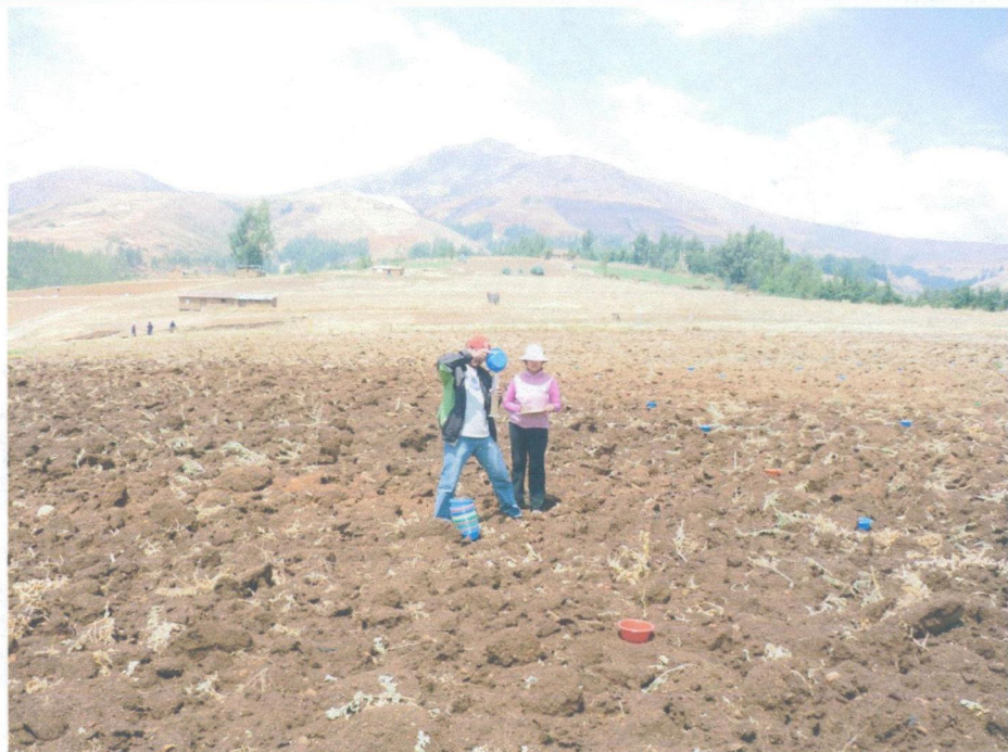
Fotografía N°04: Prueba de pluviometría en una parcela representativa del sistema de riego de la comunidad de Llutacancha.
