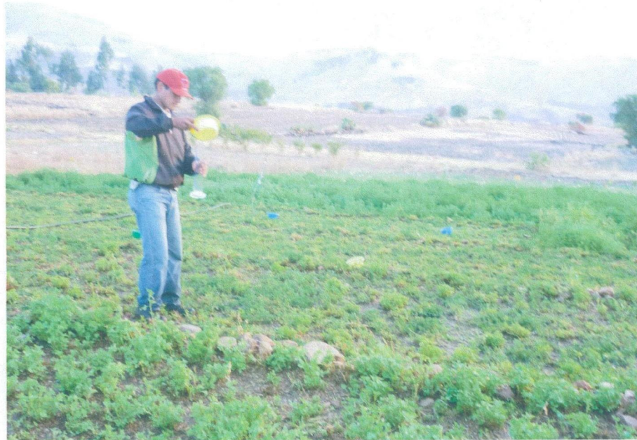
Fotografía N°12: Prueba de pluviometría en la parcela representativa – comunidad de Uchuypampa.
