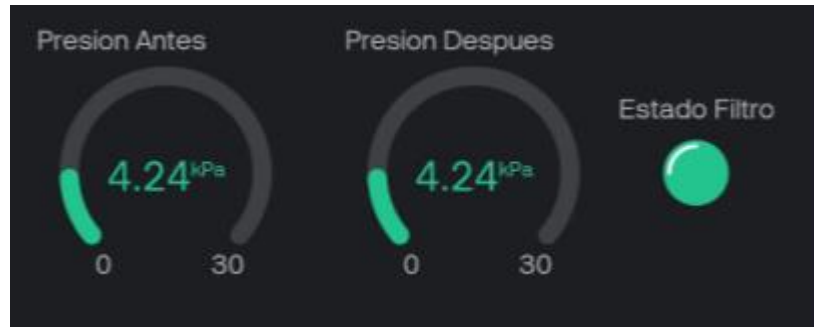
Figura 2. 63 Widgets para el control de presión antes y después del filtro de anilla
