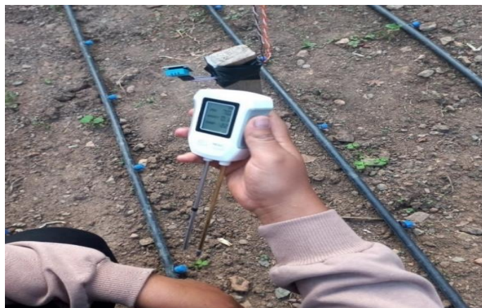
Figura 2. 57 Toma de datos para ajustar las lecturas del sensor de temperatura
