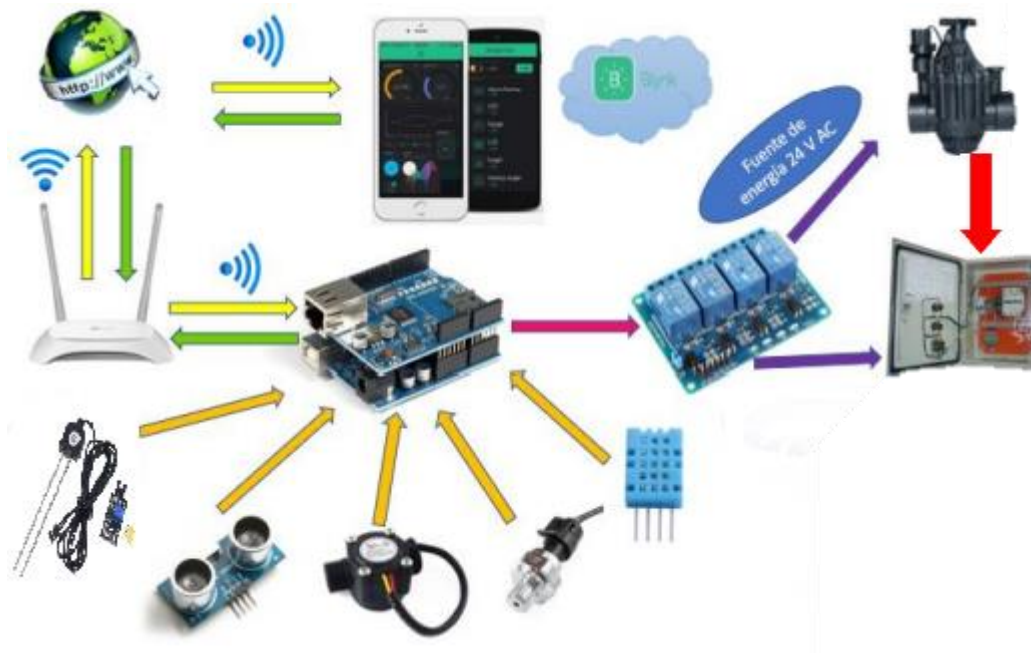
Figura 2. 61 Conexión de los sensores y actuador para el monitoreo en Blynk
