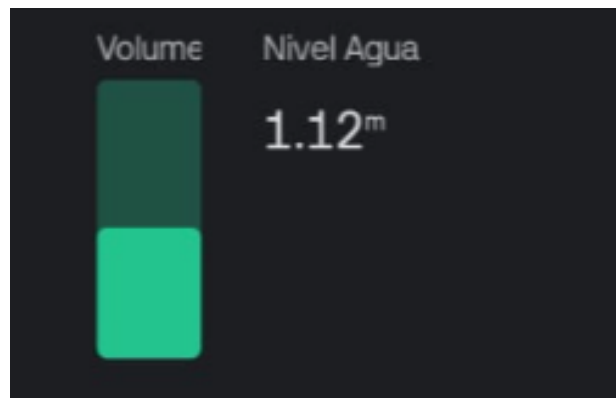
Figura 2. 64 Widgets para el control del nivel y volumen del reservorio
