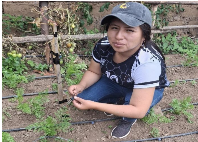
Figura 2. 59 Toma de datos para ajustar las lecturas del sensor de humedad
