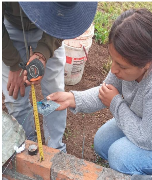
Figura 2. 50 Toma de datos para ajustar las lecturas del sensor ultrasónico HC-SR04
