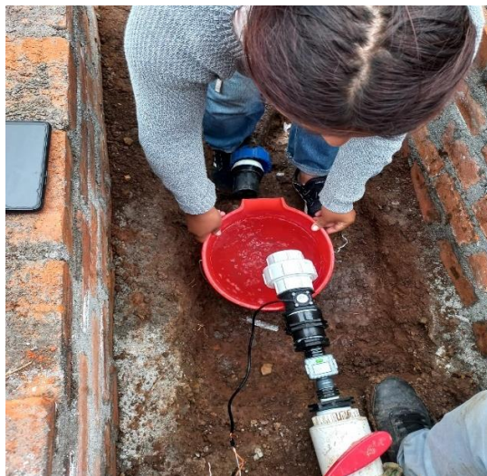
Figura 2. 55 Toma de datos para ajustar las lecturas del sensor de flujo de agua 2" YF-DN50
