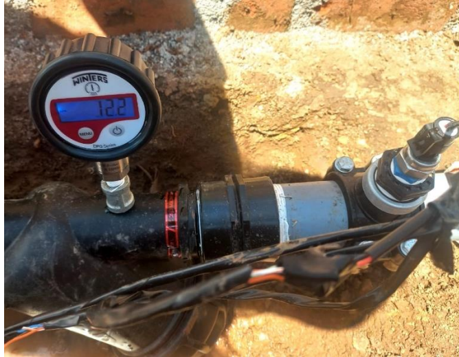
Figura 2. 52 Toma de datos para ajustar las lecturas del sensor presión HK-3025
