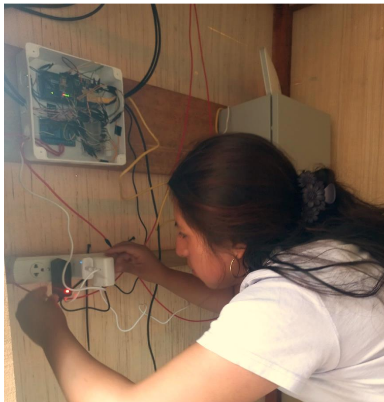
Figura 6 Implementación del microcontrolador Arduino y el sistema eléctrico en la caseta de control
