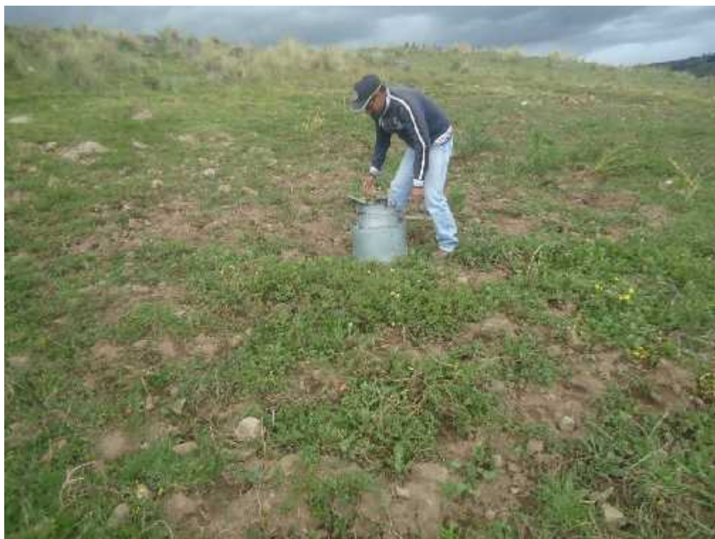
FOTO N° 12: Prueba de la velocidad de infiltración área de la intervención del proyecto- Campanayocc.
