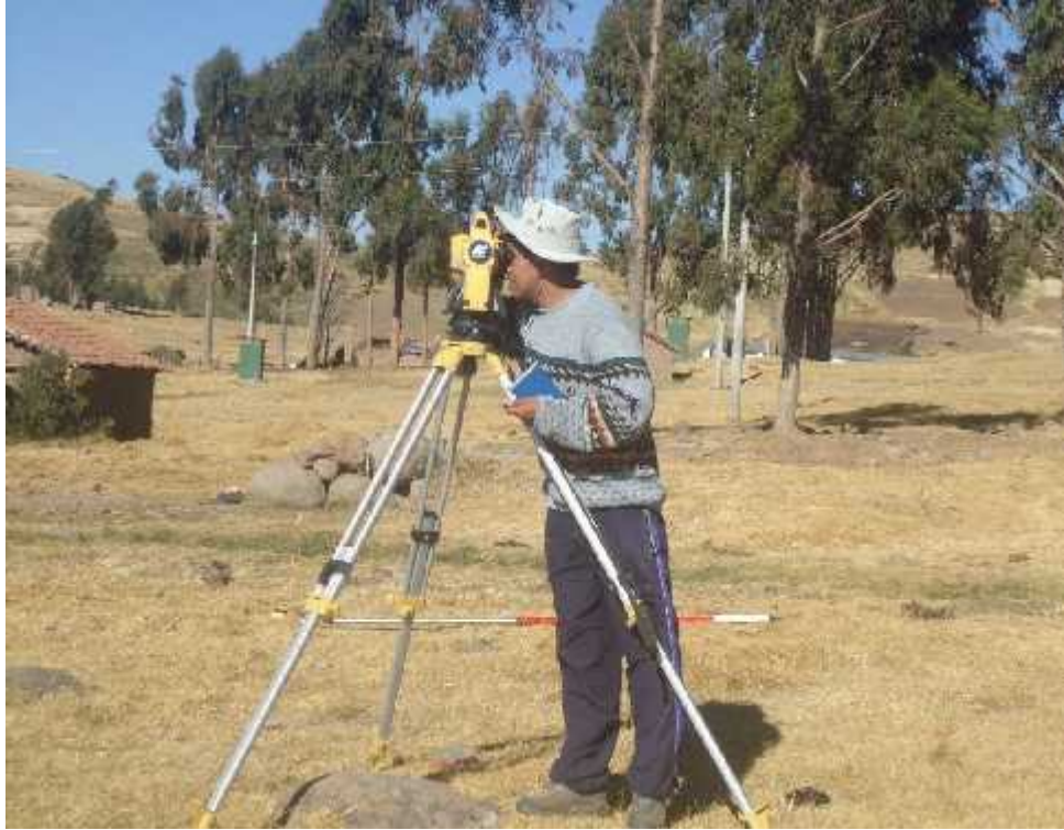
FOTO N° 09: Trabajos topográficos para el planteamiento del Esquema Hidráulico - Campanayocc.
