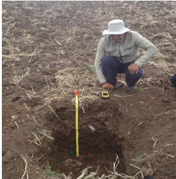
Figura N° 3.5: Apertura de la Calicata – En la Intervención del Proyecto
