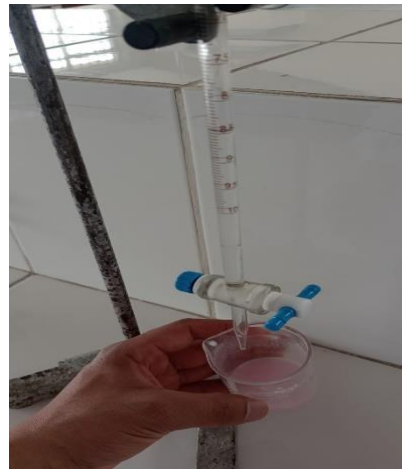
Figura 48 Determinación de acidez en el yogur griego
