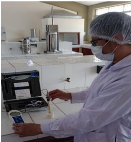
Figura 31 Control de pH en la leche
