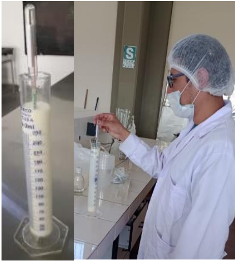
Figura 29 Prueba de densidad de la leche
