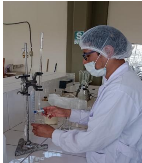
Figura 30 Determinación de acidez en la leche
