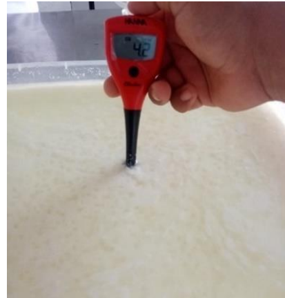
Figura 40 Control del pH en la fermentación
