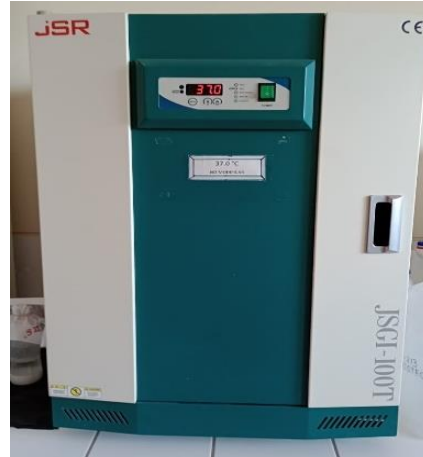
Figura 58 Incubadora regulada a 37°C
