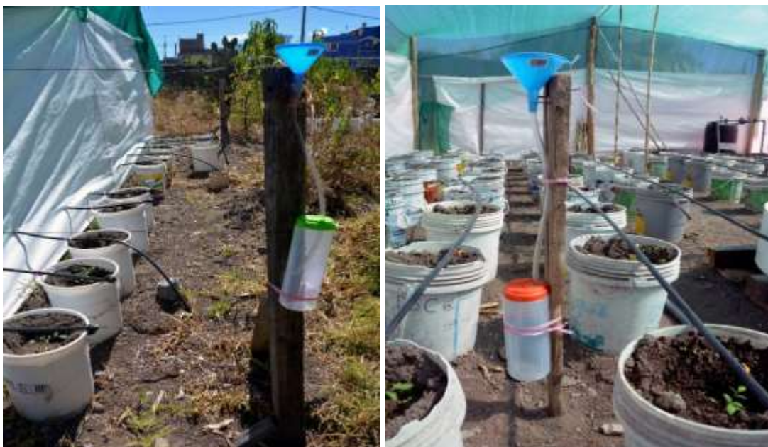
Figura 2.5: instalación de pluviómetro interior y exterior.
