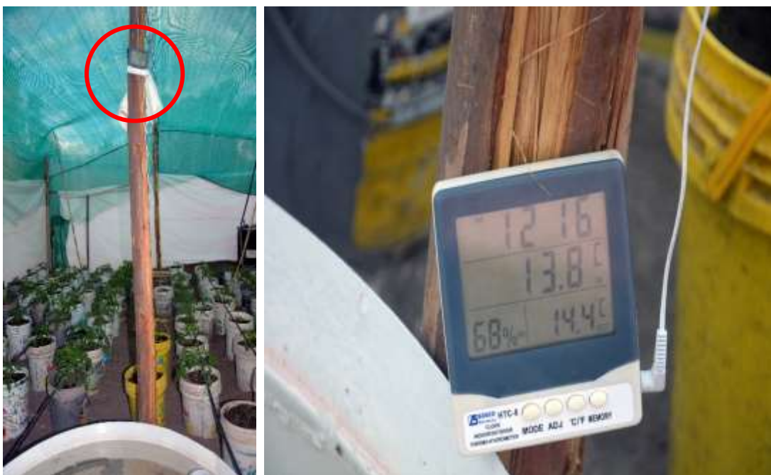
Figura 2.6: instalación de termómetros digital
