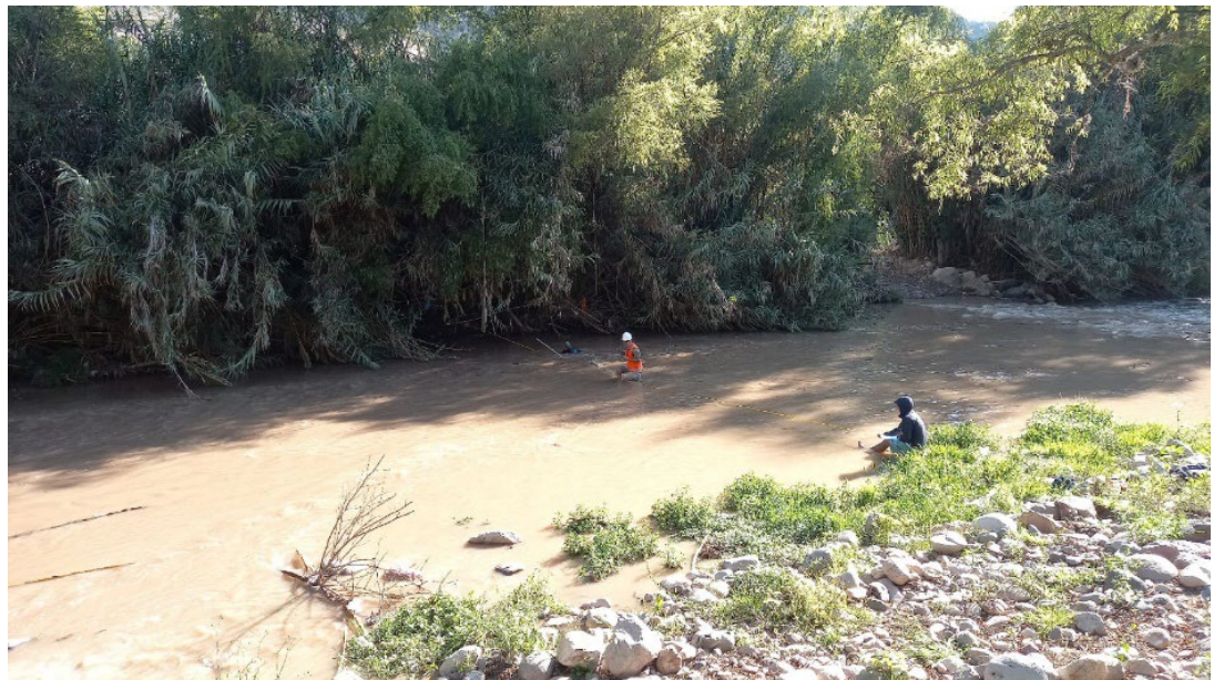
Fotografía : seccionamiento transversal del cauce del rio cada medio metro.
