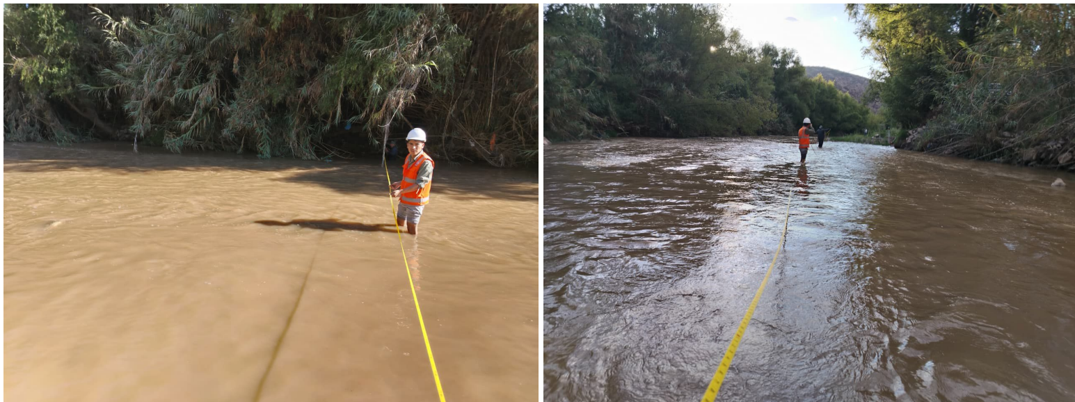
Fotografía : Toma de medidas como: ancho de cauce y longitud de cada tramo.
