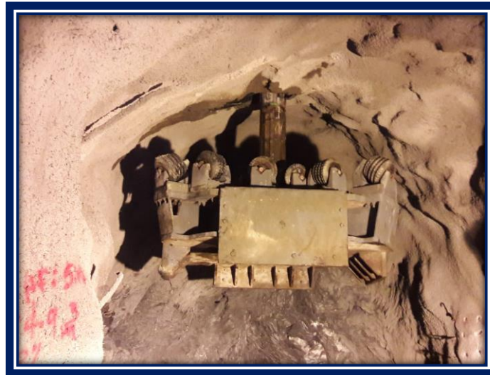
Figura 27 Escariador conectado en columna de perforación
