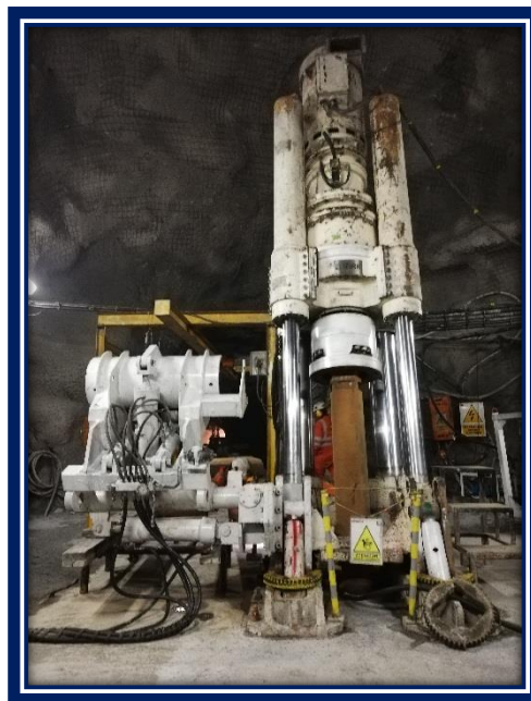
Figura 5 Máquina Raise Boring
