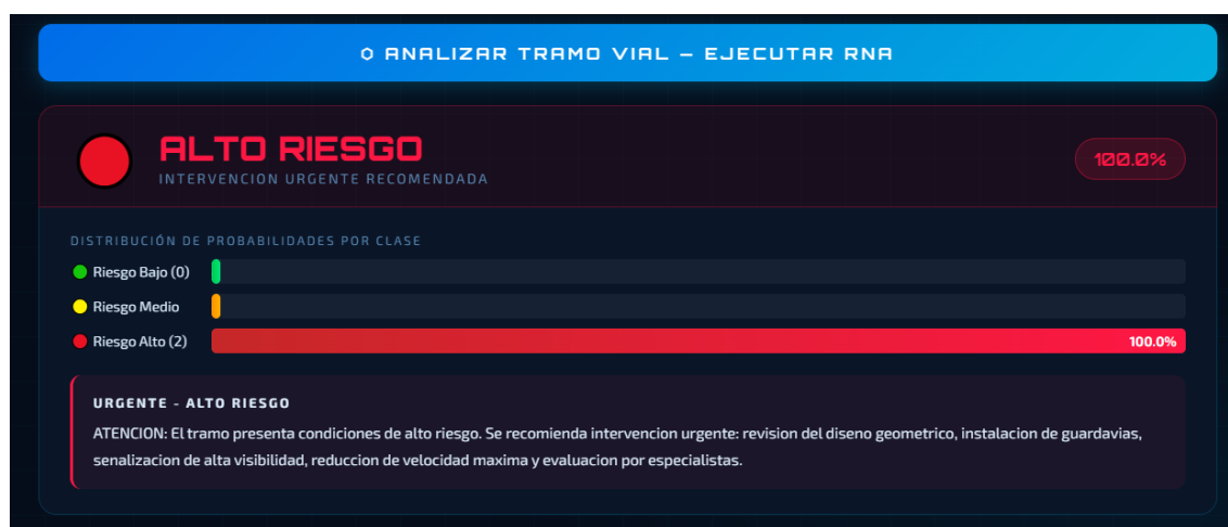
Figura 196 Ejecutar e interpretar en caso Riesgo Alto.
