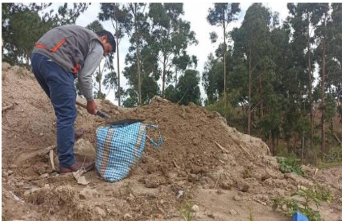
Fotografía 1: Recolección de muestra de tierra para laboratorio
