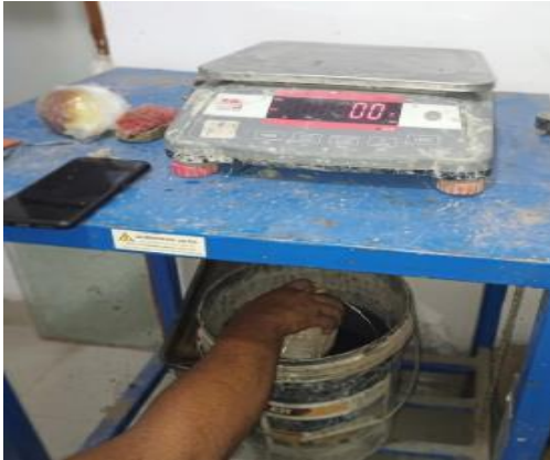
Figura 57. Proceso de sumergido de muestra de adobe patrón con parafina.
