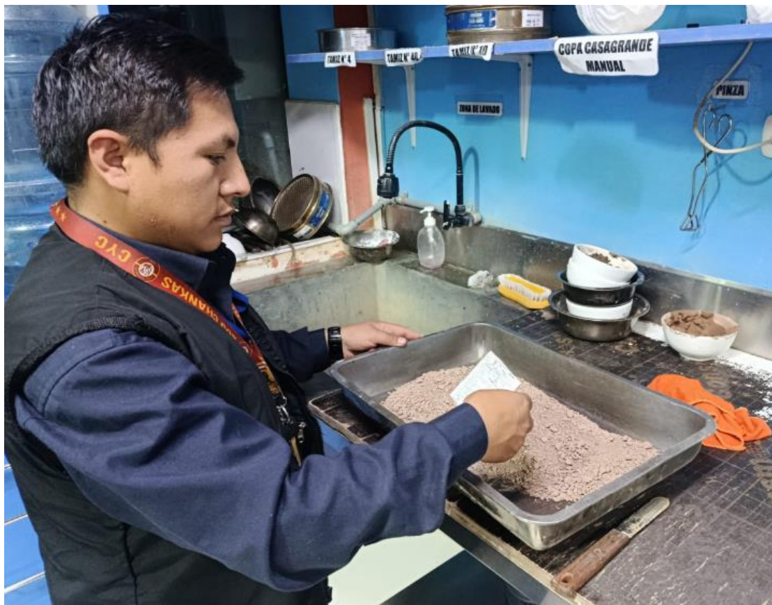
Fotografía 5: Separación de materiales utilizando la malla N°4
