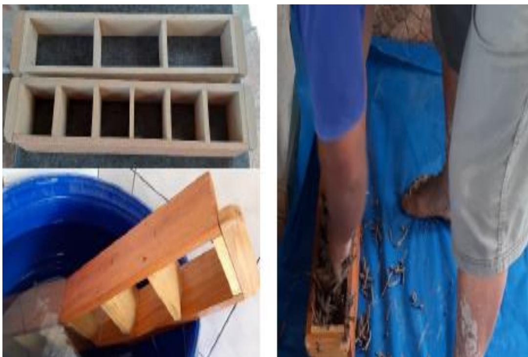
Fotografía 7: Colocación de la mezcla en los moldes de cubos y ladrillos
