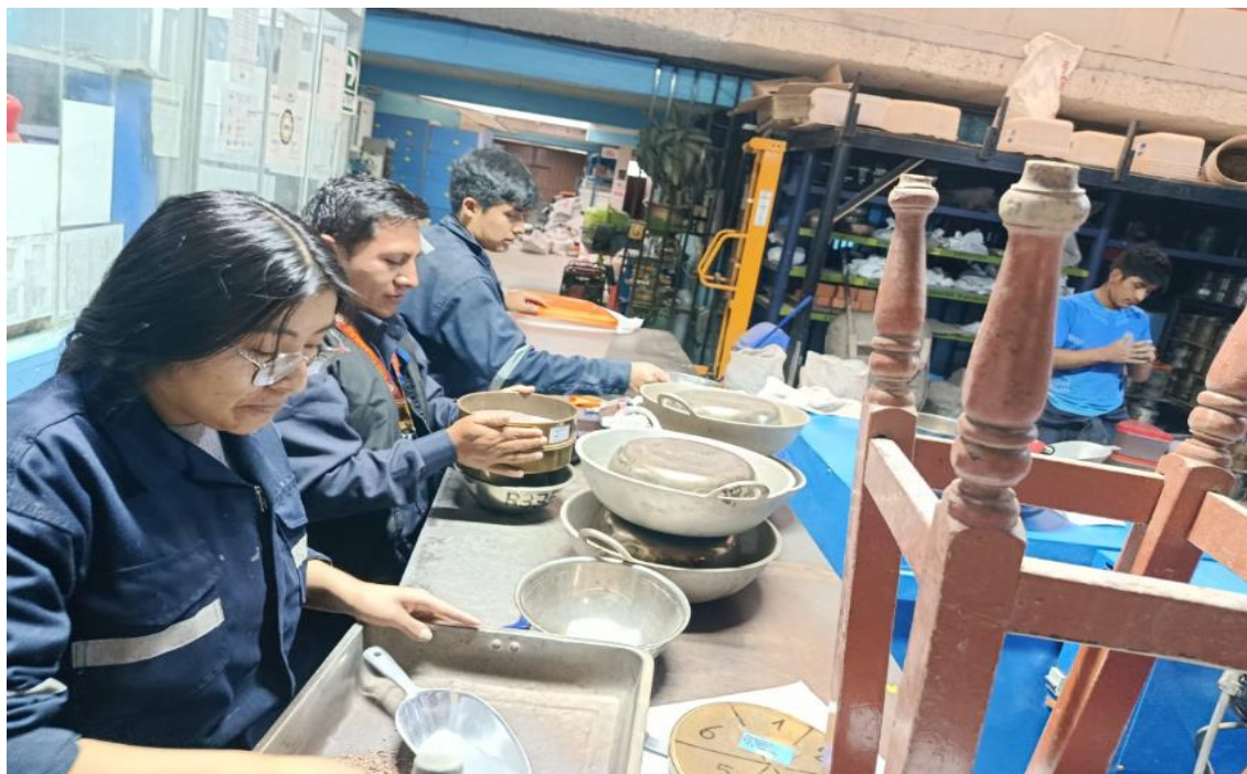
Fotografía 5: Separación de materiales utilizando la malla N°4
