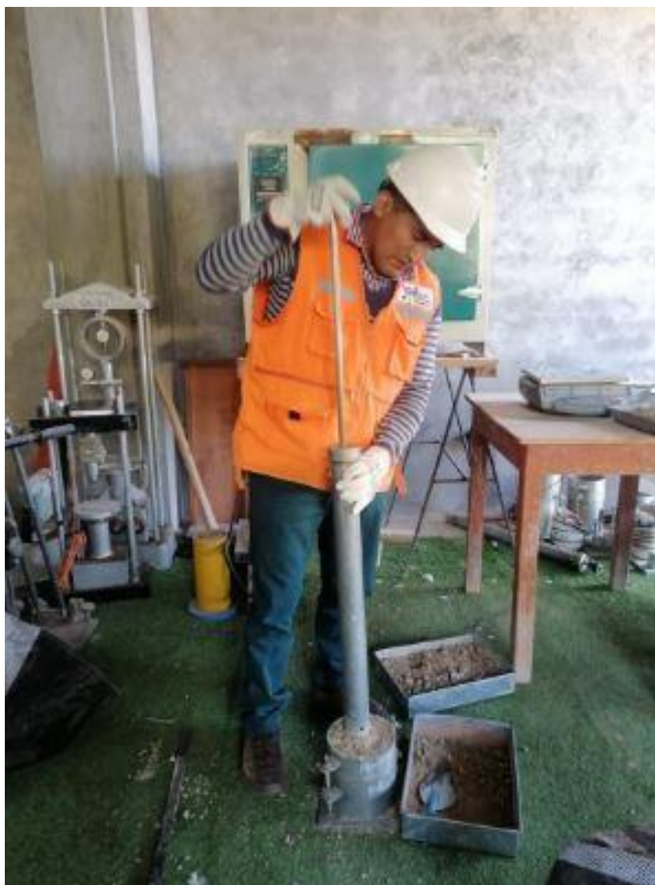
Figura A.6: Ensayos de laboratorio de Proctor.
